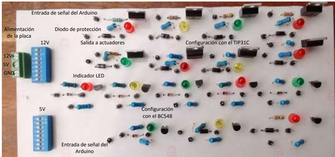
Figura 34. Tarjeta de activación de actuadores
