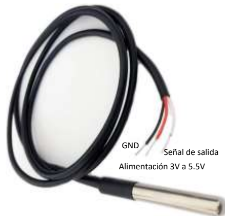
Figura 8. Sensor de temperatura DS18B20
