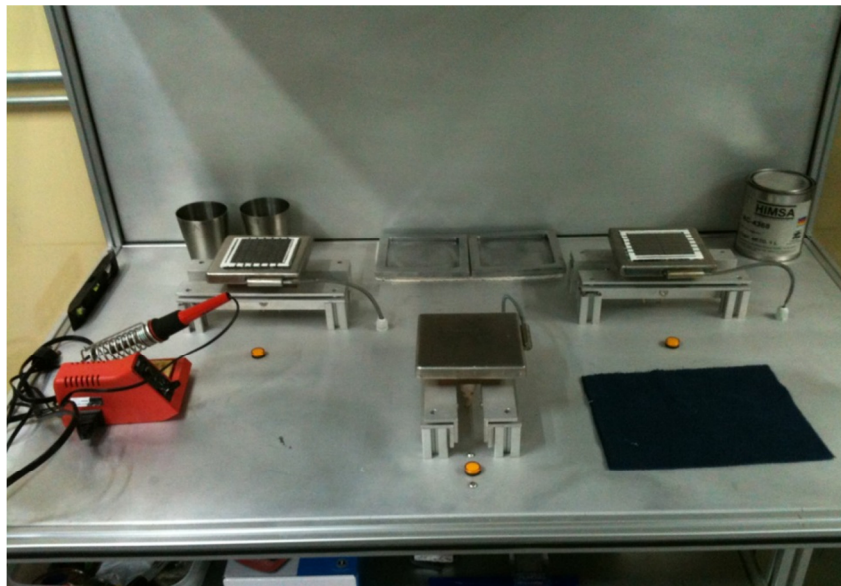
Figura 23. Estación de encapsulado y sus principales herramientas. Manual de procesamiento IPN
