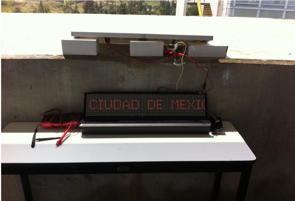
Figura 27. PMV alimentado por módulos fotovoltaicos de segunda generación. Propia realización
