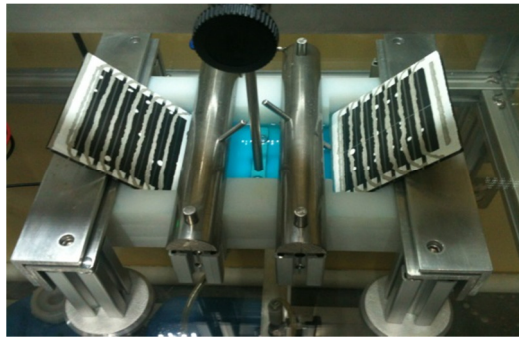
Figura 22. Proceso de depósito de pistas de cobre por electrolisis. Manual de procesamiento IPN
