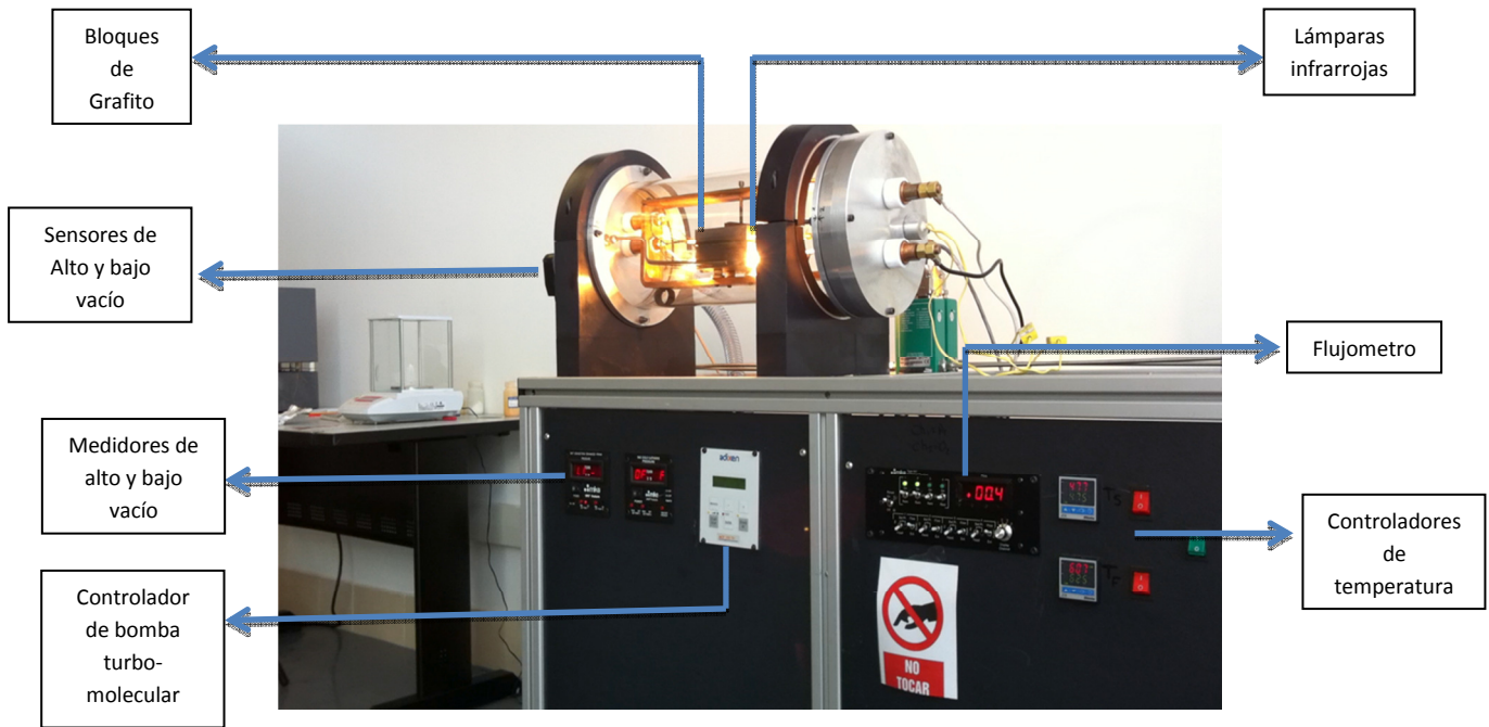
Figura 16. Equipo de sublimación CSVT. Propia realización
