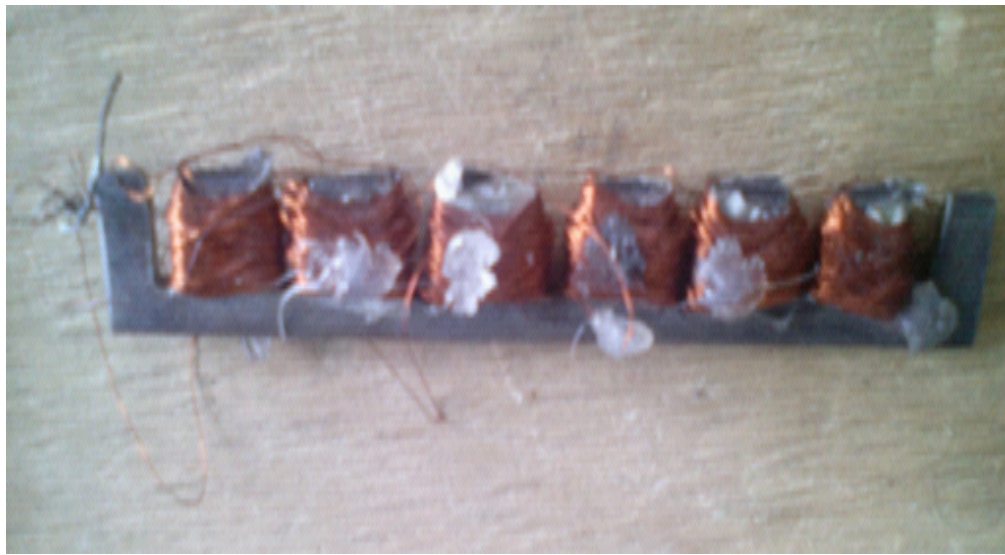
Figura 4-14: Propuesta de colocación de las bobinas en herradura consecutivas con resultado satisfactorio.
