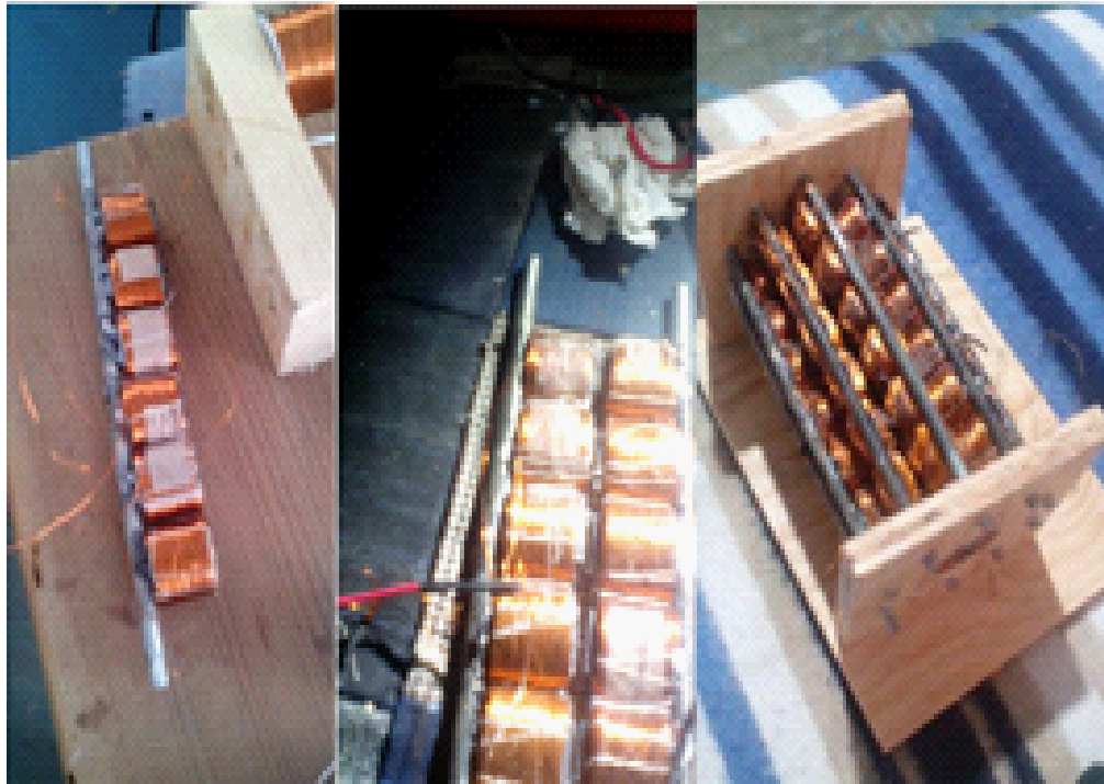
Figura 4-20: Presentación de las bobinas, prueba de respuesta de las bobinas con voltaje y presentación inicial de la colocación de las bobinas en el motor.
