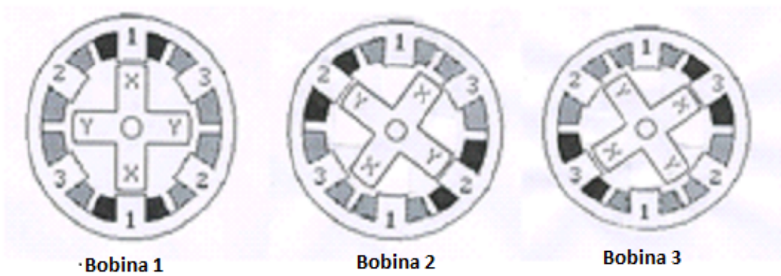
Figura 4-3: Movimiento de motor de reluctancia conmutada de 4 polos.
