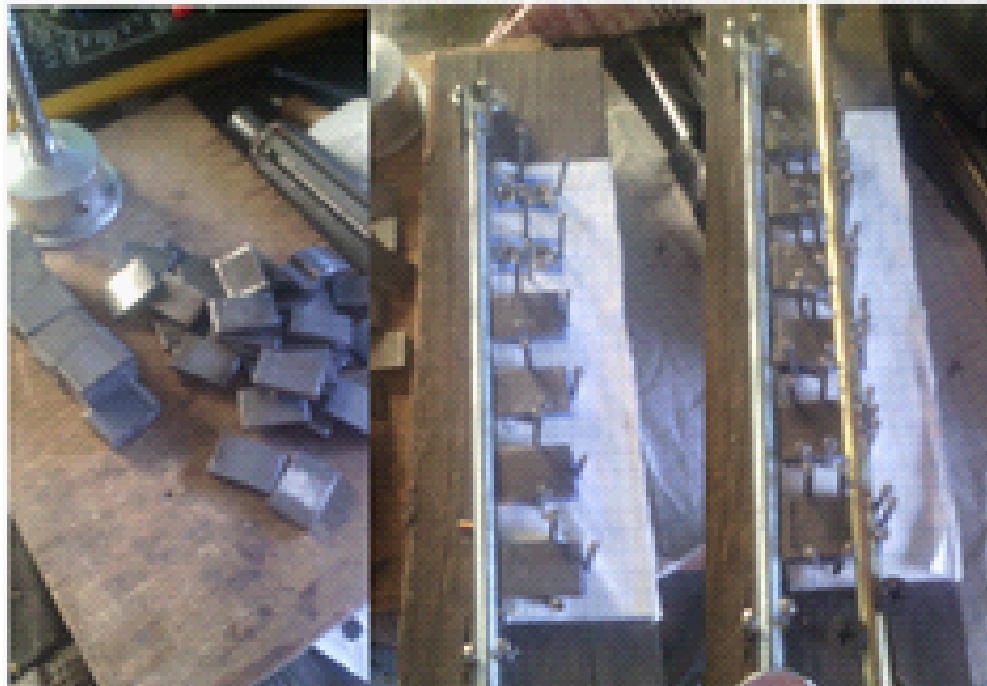
Figura 4-18: Piezas de solera y molde para soldar las soleras a las mismas distancias.
