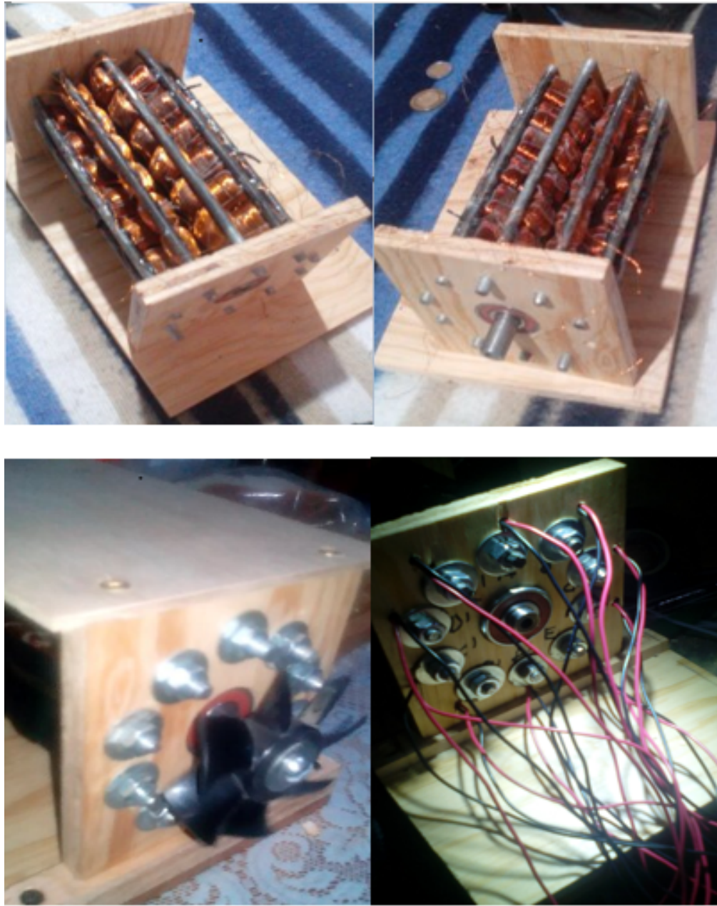
Figura 5-1: Diferentes etapas de la construcción del segundo prototipo de motor de reluctancia conmutada.
