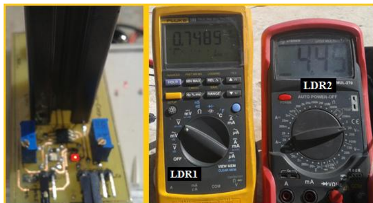
Figura 3.38 Niveles de voltaje de LDR1 y LDR2 de acuerdo a la posición del Sol
