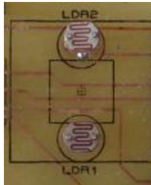
Figura 3.33 Disposición de los fotorresistores para la captación de luz solar
