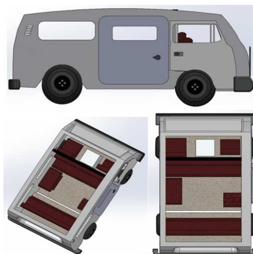
Figura 19 Estructura de la combi y posición de los asientos,
