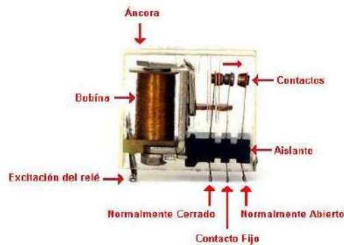
Figura 2.22: Relevador, relé o relay. [Aguillon.2013]
