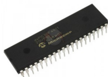
Figura 3.22: Fotografía de dsPIC30F4011 [RS, 2015]
