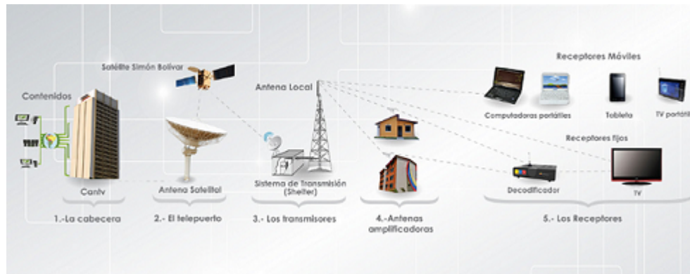
Figura 1.3: Como funciona la televisión digital (Ver en índice de imágenes [2])
