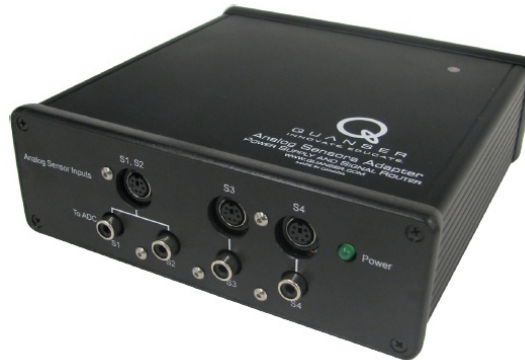
Figura A.2: Adaptador de sensores analógicos. Obtenida de http://www.quanser.com/
