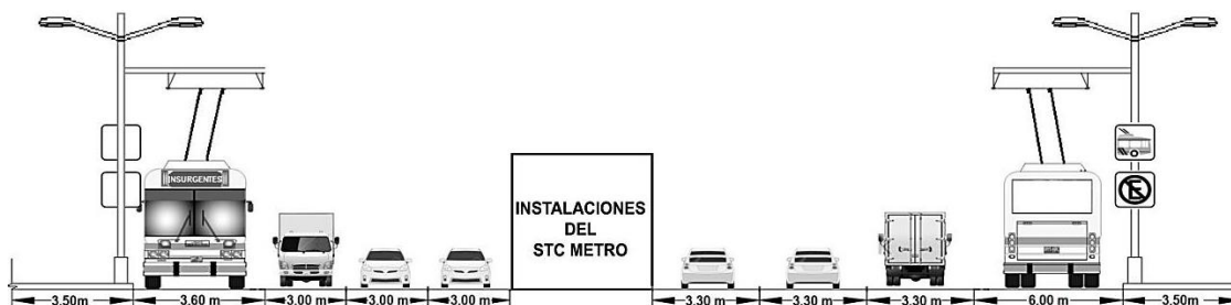
Figura 12. Sección Transversal Tipo de la Calzada Ermita Iztapalapa, desde el Metro Constitución de 1917 hacia el deportivo de Santa Cruz Meyehualco.
