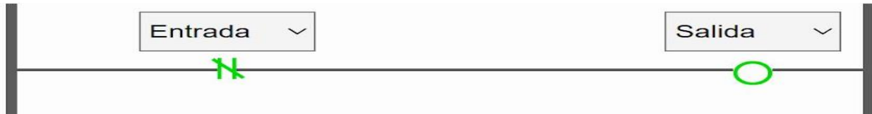
Figura 2.3. Equivalente de la compuerta NOT en diagrama escalera.
