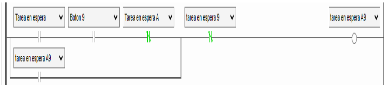
Figura 5.16. Sección del programa para tarea específica de tarea en espera A.
