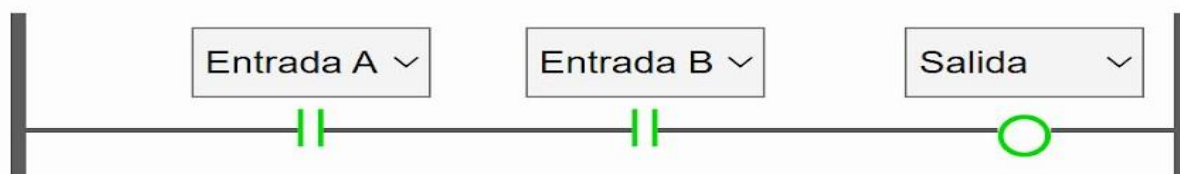
Figura 2.1. Equivalente de la compuerta AND en diagrama escalera.
