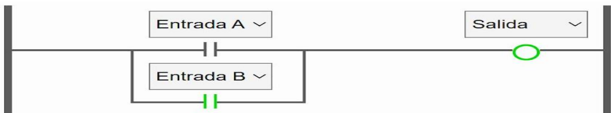
Figura 2.2. Equivalente de la compuerta OR en diagrama escalera.
