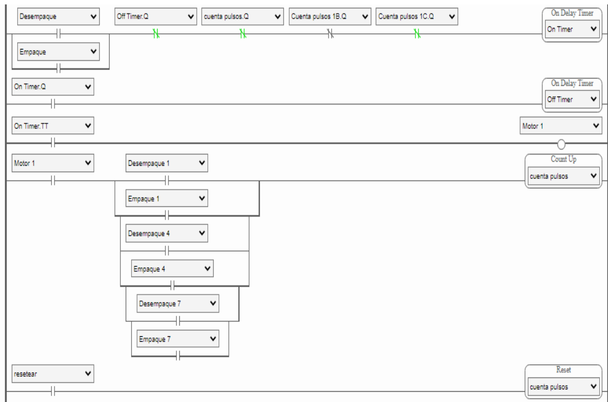
Figura 5.5.3. Sección del programa para el movimiento del motor 1 de tareas de empaque y desempaque (1,4 y 7).
