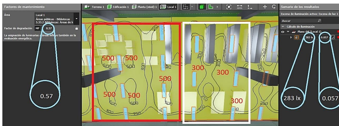
Figura 39. Acercamiento de la propuesta de diseño del sistema de iluminación en Biblioteca
