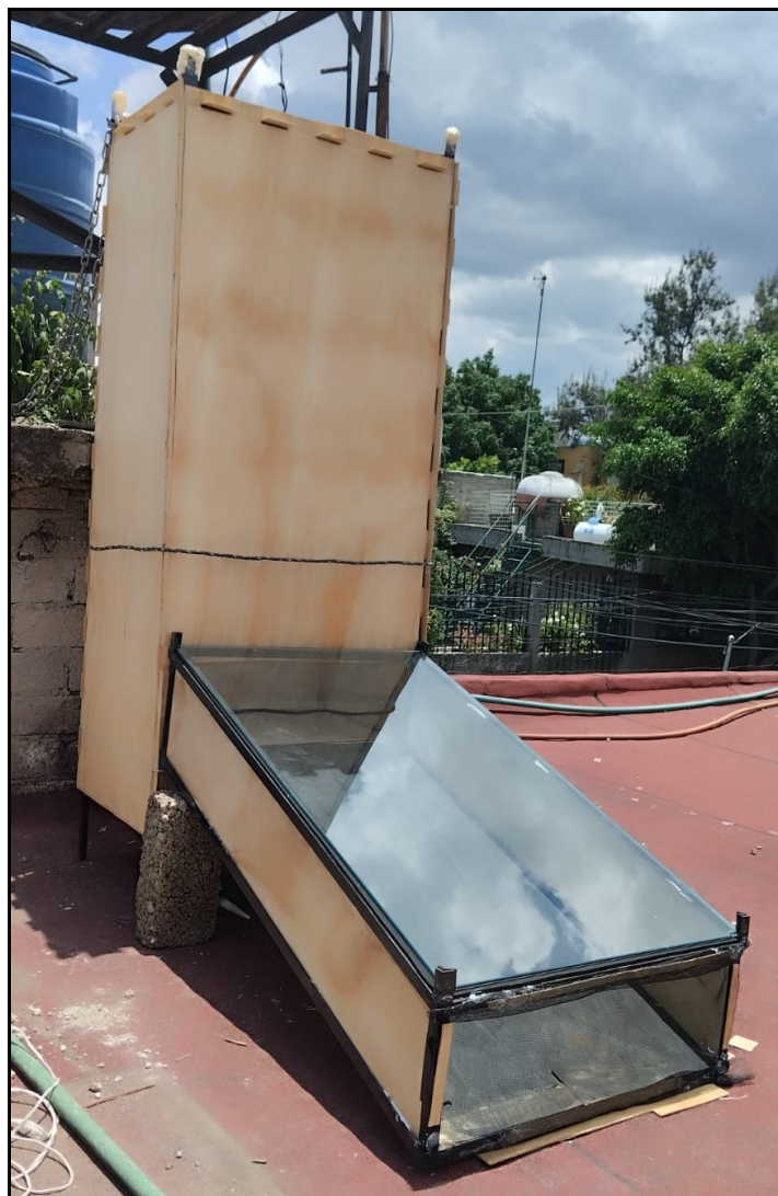
Figura 16. Construcción final del deshidratador solar (Elaboración propia)
