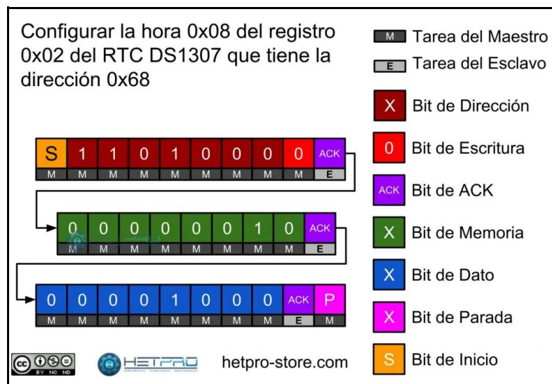
Figura 54. Registro de datos en módulo RTC con protocolo I2C
