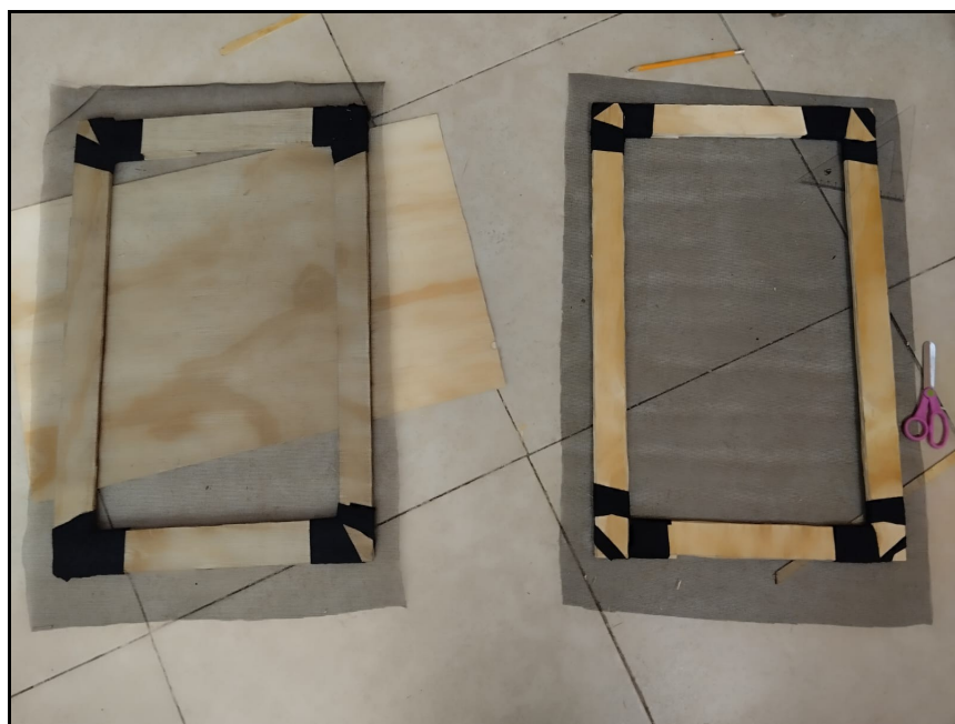
Figura 17. Marcos en proceso de creación de tripay con malla mosquitera (Elaboración propia)
