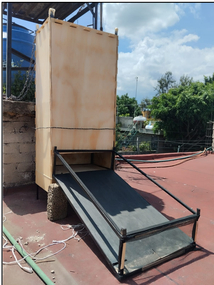
Figura 15. Colocación de espuma vinilo sobre colector
