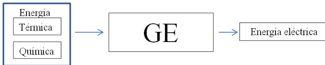
Figura I.1 Diagrama a bloques de grupo electrógeno GE, convertidores de energía
