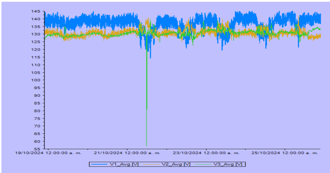
Figura 8 Gráfica del comportamiento de voltajes por fase obtenidos del analizador de redes (fuente: Elaboración propia).
