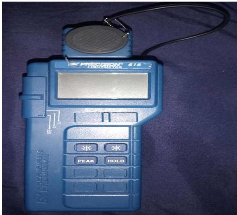
Figura 50 Luxómetro SK PRECISION LIGHT METER (fuente: elaboración propia).
