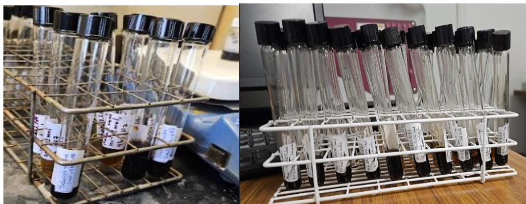
FIGURA 7.3. PREPARACIÓN DE MUESTRAS DE LA HIDRÓLISIS BÁSICA PARA SU SER ANALIZADOS EN EL ESPECTRÓMETRO. FUENTE: ELABORACIÓN PROPIA.
