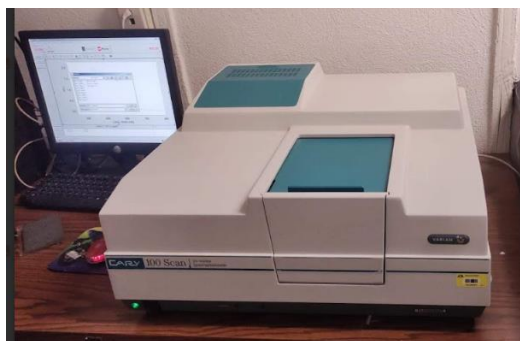
FIGURA 19. ESPECTRÓMETRO UTILIZADO COMO HERRAMIENTA PARA DETERMINAR NIVELES DE AZÚCARES OBTENIDOS POR LA HIGUERILLA. FUENTE: ELABORACIÓN PROPIA.
