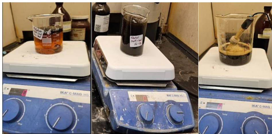
FIGURA 6.3. PROCESO DE LA HIDRÓLISIS BÁSICA (NaOH) EN LA HIGUERILLA. FUENTE: ELABORACIÓN PROPIA.
