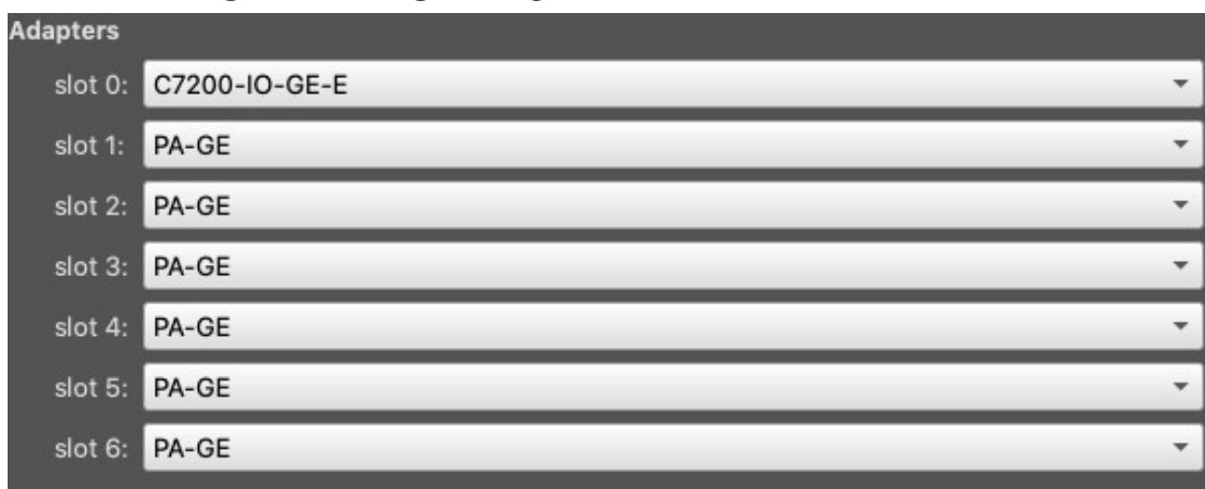
Figura 3.4. Slots disponibles en el router c7200.
