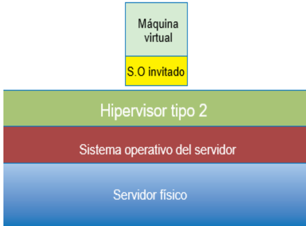
Figura 2.6: Ejemplo de un Hipervisor tipo 2 [Fuente: M. Portnoy, Fundamentos de la virtualización, Hoboken, Nueva Jersey, Estados Unidos: Sybex, 2023.]
