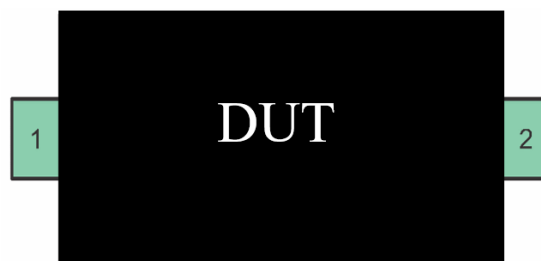
Figura 1.9. Dispositivo Bajo Prueba, con dos puertos.
