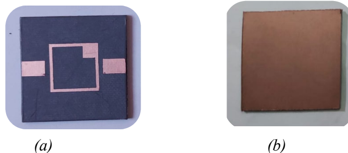
Figura 3.18. Grabado del circuito. (a) Vista superior del sensor. (b) Vista del reverso del sensor.
