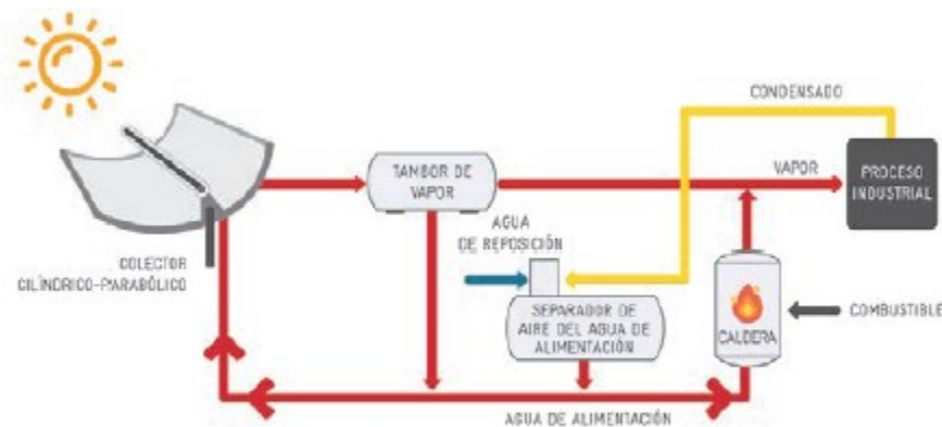
Figura 35. Sistema solar que suministra calor directamente a un proceso industrial
