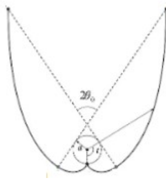
Figura 40. Geometría del CPC con receptor circular
