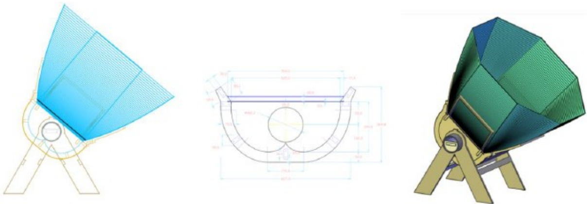
Figura 33. Diseño conceptual del Tolokatzin 2020. A) Vista lateral, B) Cavidad del absorbedor, C) Vista isométrica
