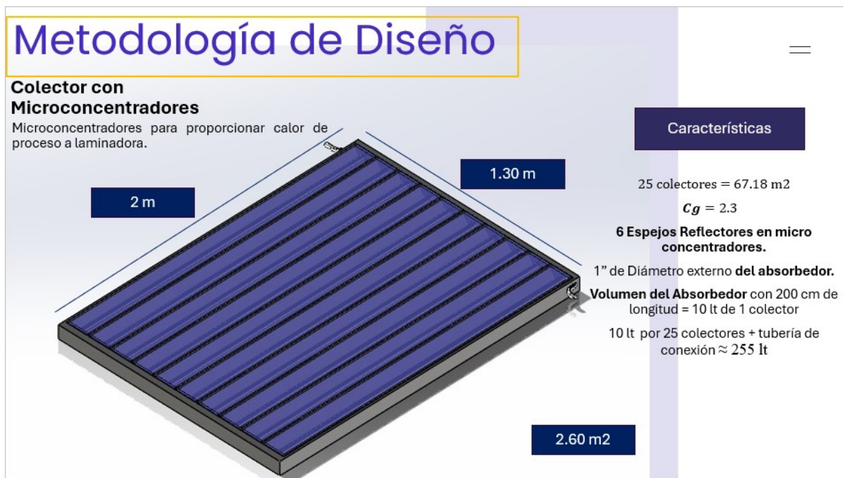
Figura 76. Colector con micro concentradores y características principales
