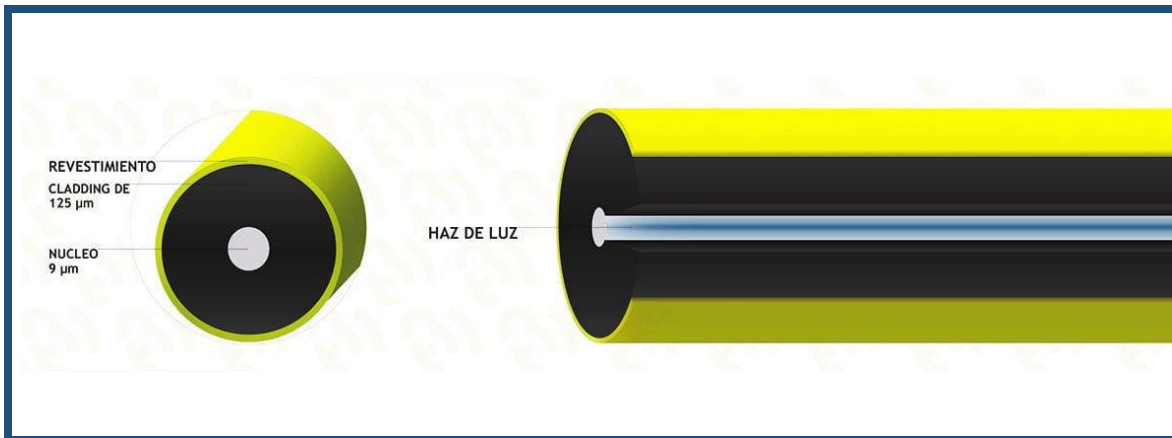
Figura 9: Geometría de una fibra óptica monomodo.
