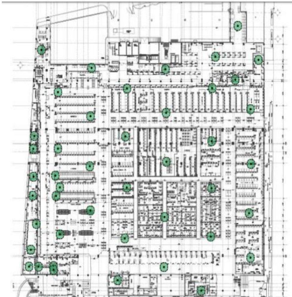
Figura 13: Colocación de Ap's
