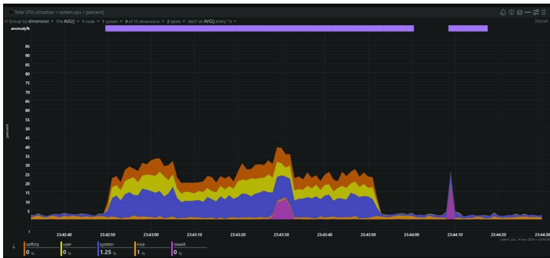
Figura 4.5 Consumo de recurso del CPU del balanceador con una carga de 55 instancias con 250 usuarios durante un minuto. [Figura generada con el software de monitoreo Netdata].
