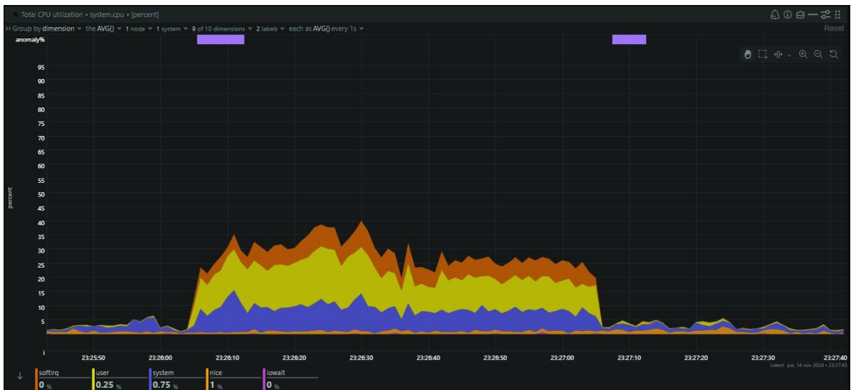
Figura 4.3 Consumo de recurso del CPU con carga durante un minuto, 55 instancias con 250 usuarios cada una. [Figura generada con el software de monitoreo Netdata].
