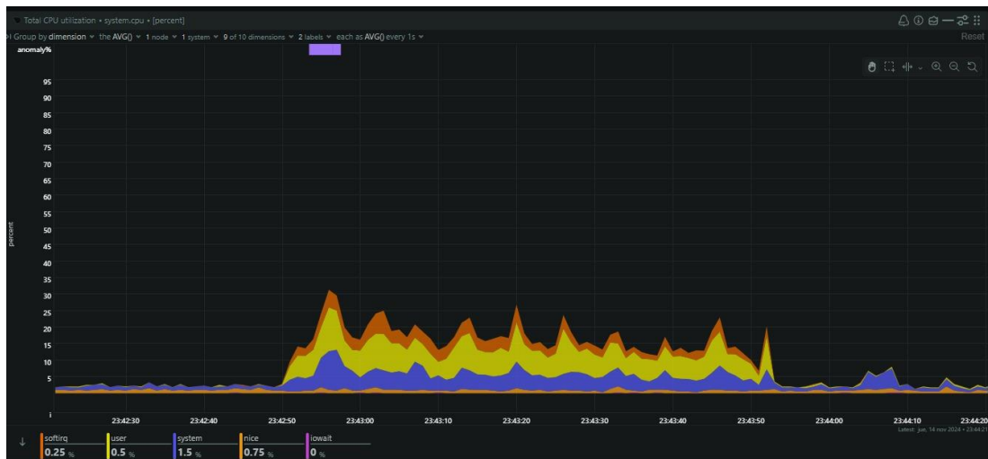
Figura 4.4 Consumo de recurso del CPU del servidor en el balanceador con una carga de 55 instancias con 250 usuarios durante un minuto. [Figura generada con el software de monitoreo Netdata].
