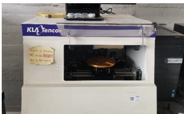
Figura 10. Perfilómetro de LACyTES. Fuente: Elaboración propia.
