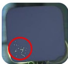
Figura 4. Pinholes en celda solar después del depósito de CdTe. Fuente (Reyes García, 2020).
