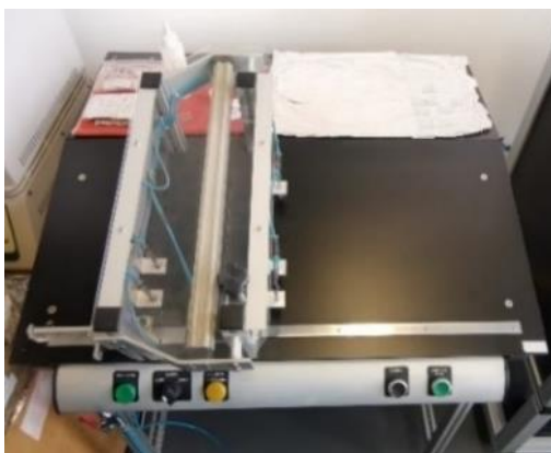
Figura 13. Cortadora de vidrio alimentada por aire comprimido CVRF-1.2. Fuente: Elaboración propia.
