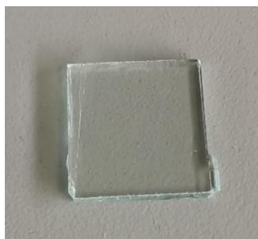
Figura 14. Vidrio TEC 15 sin lijar. Fuente: Elaboración propia
