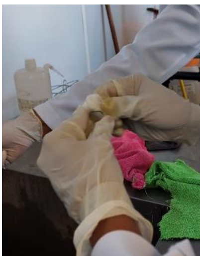
Figura 16. Lavado con jabón alcalino.
