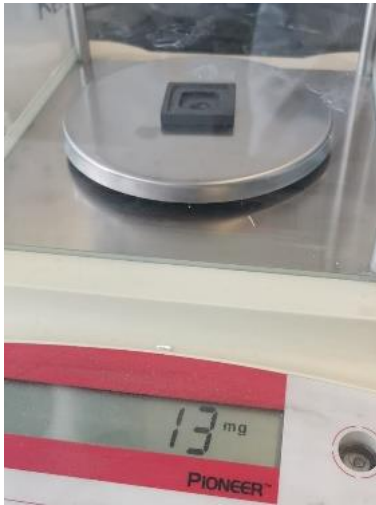
Figura 20. 13 mg de CdTe para su depósito.
