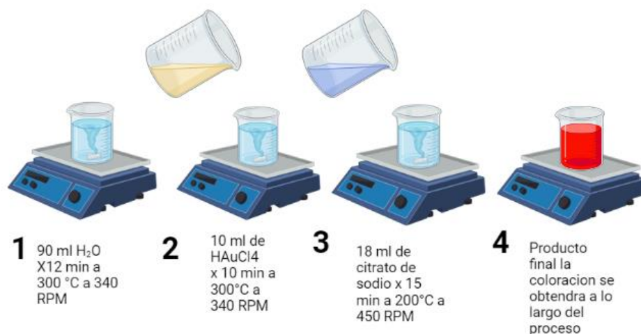
Figura 9. Procedimiento realizado para la síntesis de la AuNP's mediante reducción química. 1) Calentamiento del agua Milli Q. 2) Adición del ácido tetracloraurico. 3) agregación del agente reductor (citrato de sodio). 4) coloración final de la síntesis de las AuNP's.
