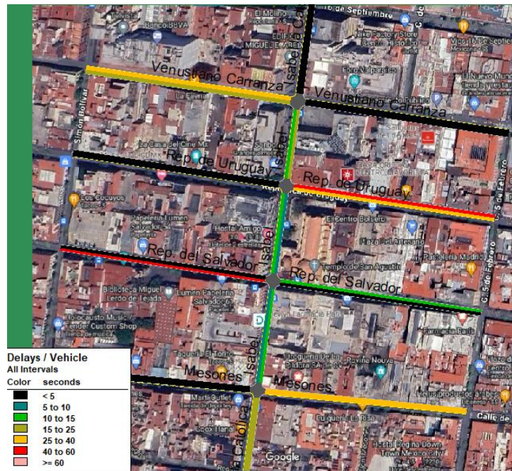
Figura 6.3. Demoras de las condiciones actuales.
