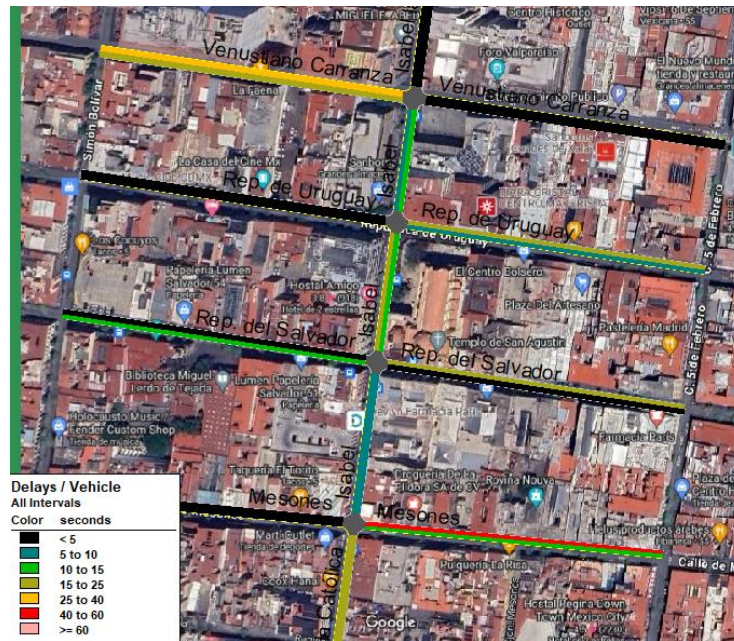
Figura 7.3. Demoras de la mejora de bajo costo por intersección.
