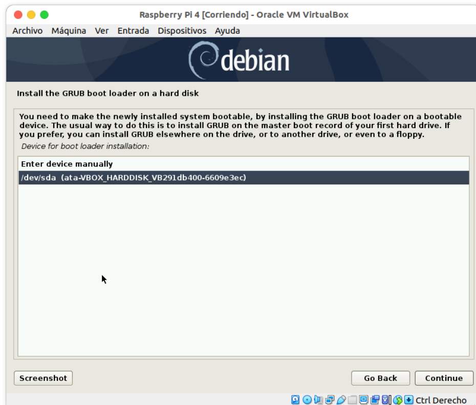
Figura 23. Seleccionado la ubicación donde se instalará el GRUB.
