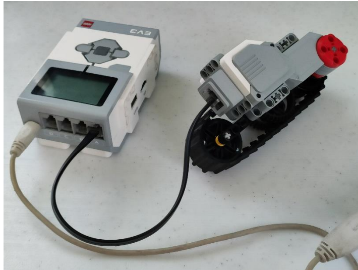
Figura 72. Conectando un motor grande al Brick del EV3 en los puertos de salida.
