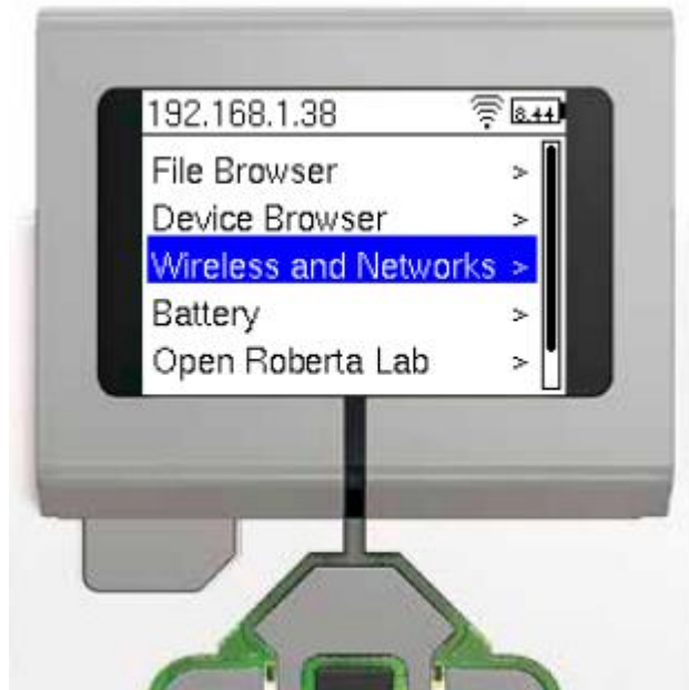
Figura 67. Menú de inicio de ev3dev en el brick del robot lego EV3.
