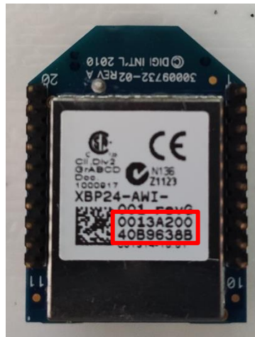
Figura 84. Módulo B Xbee Serie 1 Pro.
