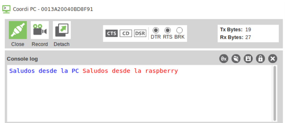
Figura 92. Panel de consola de XCTU del módulo Coordinador. Recibiendo mensaje de la Raspberry Pi.
