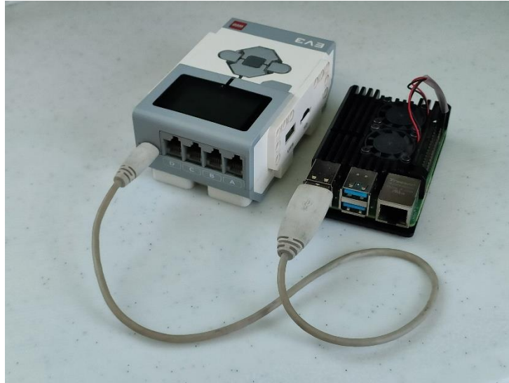
Figura 71. Conectando el Brick del EV3 con la Raspberry Pi.
