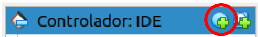
Figura 12. Opción encerrada en círculo rojo para agregar una unidad óptica a máquina virtual.
