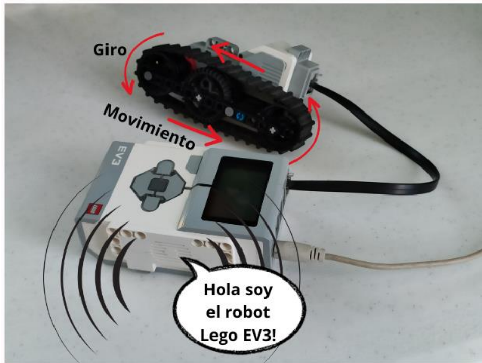
Figura 74. Resultado tras ejecutar el script desde la Raspberry Pi para dar órdenes al Brick del EV3.
