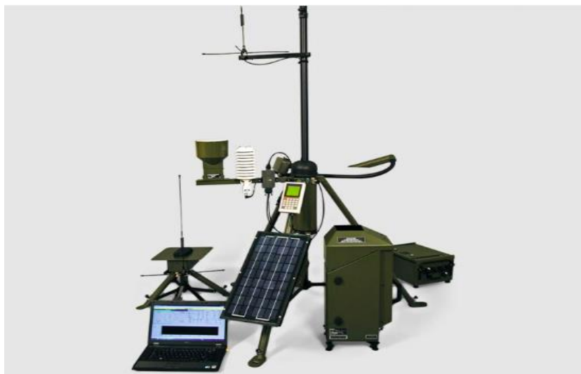
Figura 2.5 Estación meteorológica compacta de la marca Vaisala.
