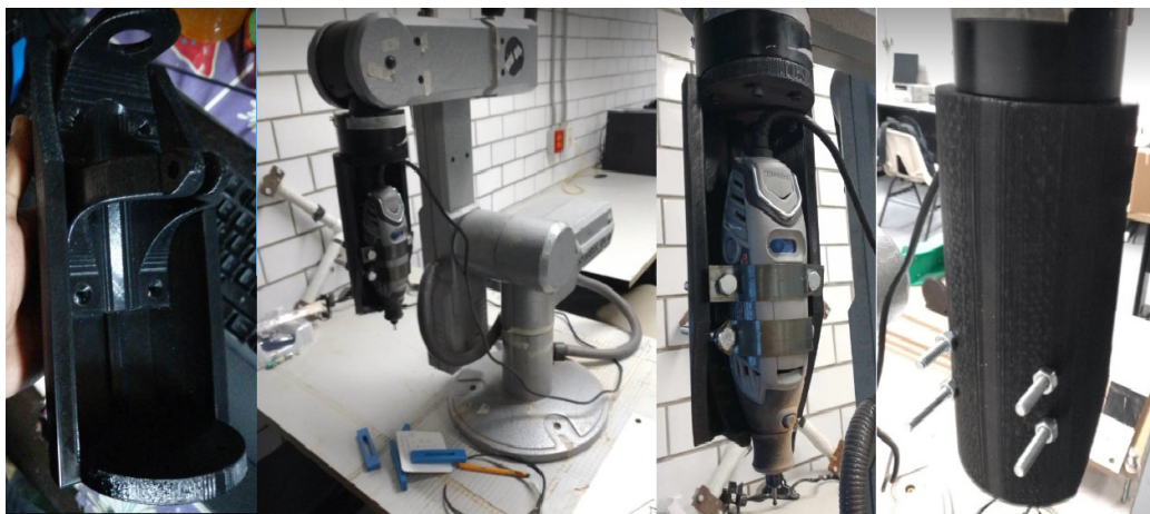
Figura 7.18: Dremel 3000 adaptado como efector final.
