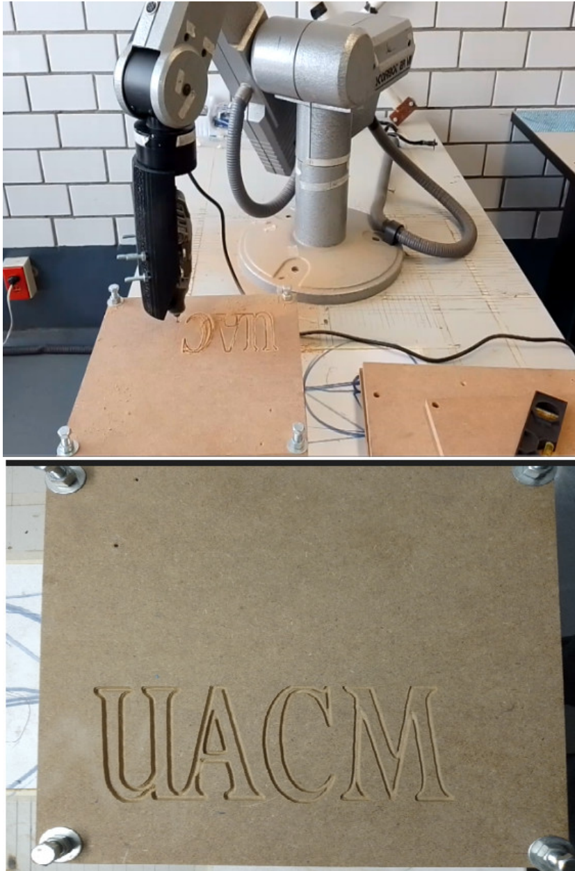
Figura 7.23: Logo UACM realizado con código G, utilizando el Scorbot ER-VII .
