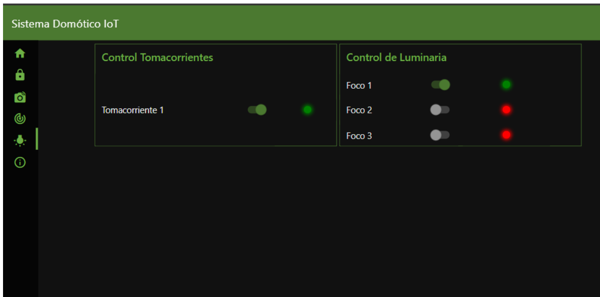
Figura 14. Control Cargas Eléctricas.
