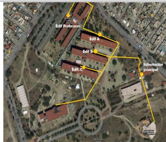
Figura 2.2 Ruta del sistema de distribución en anillo UACM-SLT Fuente. Elaboración propia, con planos del sistema eléctrico de UACM-SLT.
