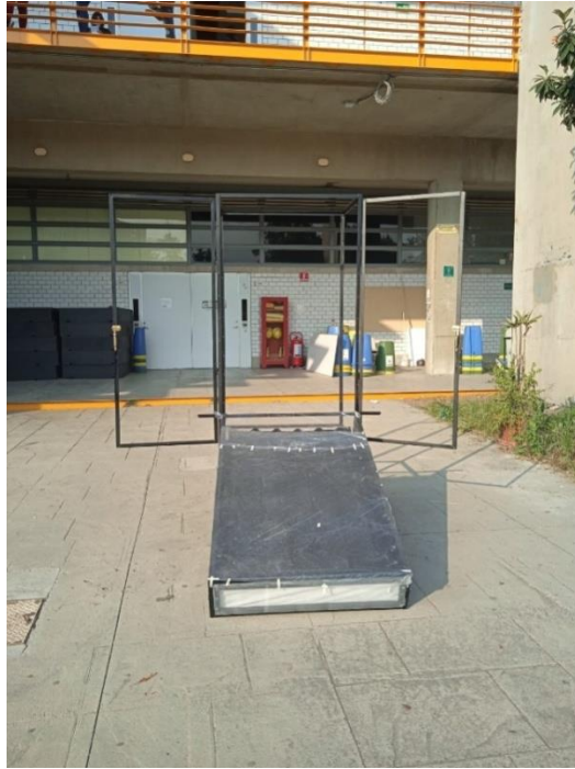
Ilustración 31: Acabado del colector solar. Elaboración propia.
