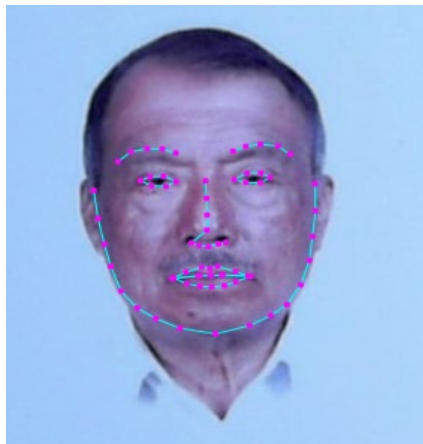
Figura 3.5: Ejemplo de cómo se dibujan los Puntos de referencia con Face-api.
