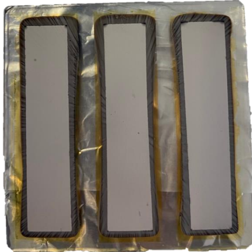
Figura 22. Muestra con depósito de Cu-Mo en áreas de 100 \text{ cm}^2 , reduciendo el área del Cu-Mo con el uso de cinta kapton por Sputering-DC sobre PEDOT:PSS.
