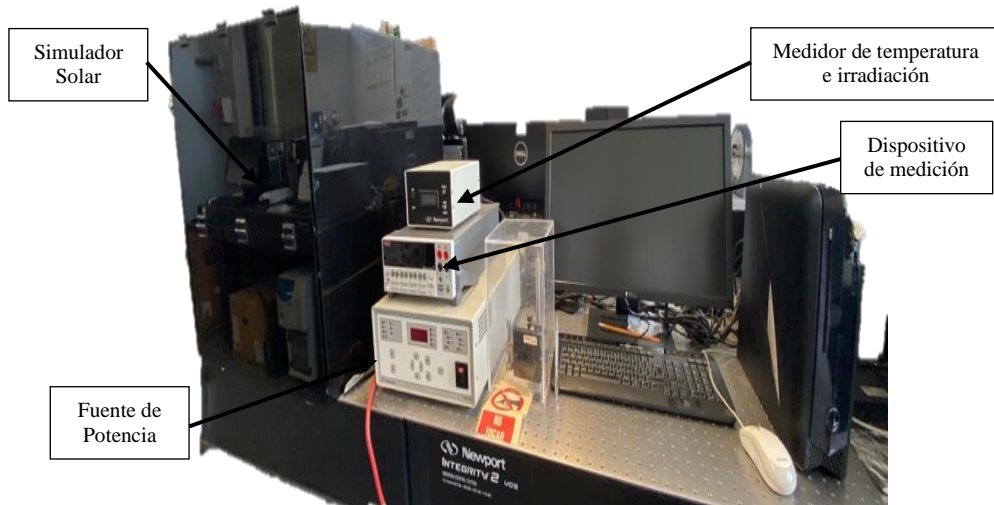
Figura 32. Simulador solar (Oriel certificado clase AAA).
