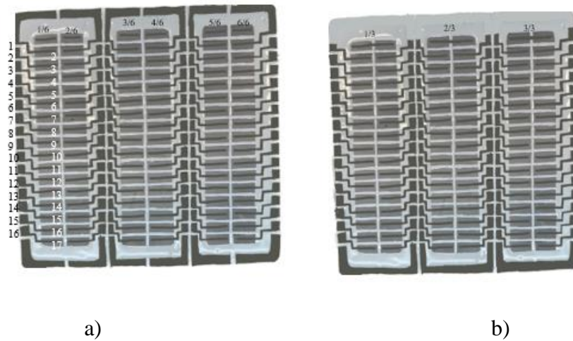
Figura 28. a) Interconexión en serie, sextos de módulo, b) Interconexión en paralelo, tercios de módulo
