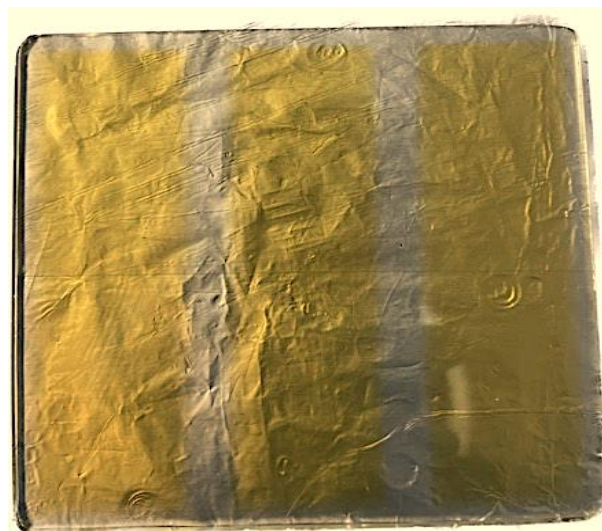
Figura 14. Muestra con depósito de ZnO/CdS por Sputering-RF sobre SnO 2 :F.
