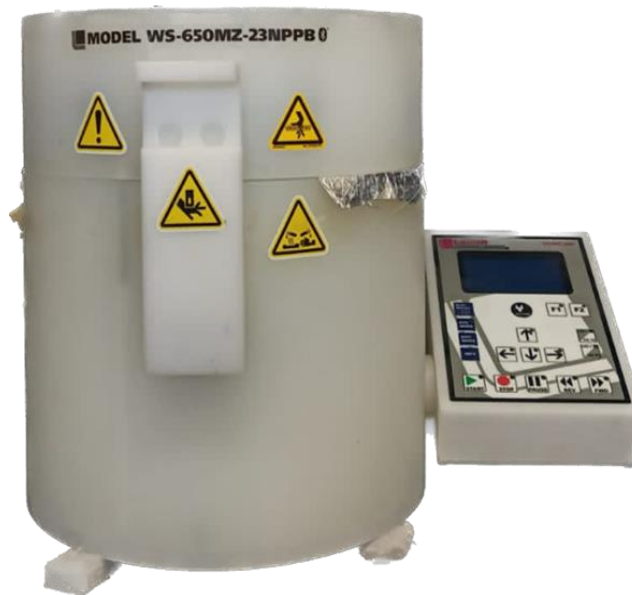
Figura 19. Spin Coating (WS-650) depósito para las películas de PEDOT:PSS.
