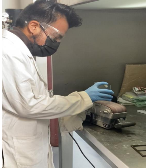
Figura 11. Lijado de sustrato.
