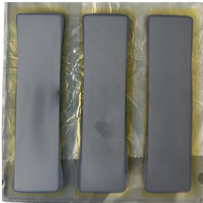
Figura 16. Muestra con depósito de CdTe sobre ZnO+CdS por CSS en áreas de 100 cm 2 , reduciendo el área del CdTe.
