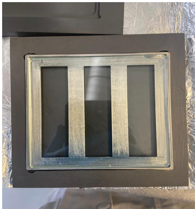
Figura 40. Plantilla limpia colocada en base de grafito.
