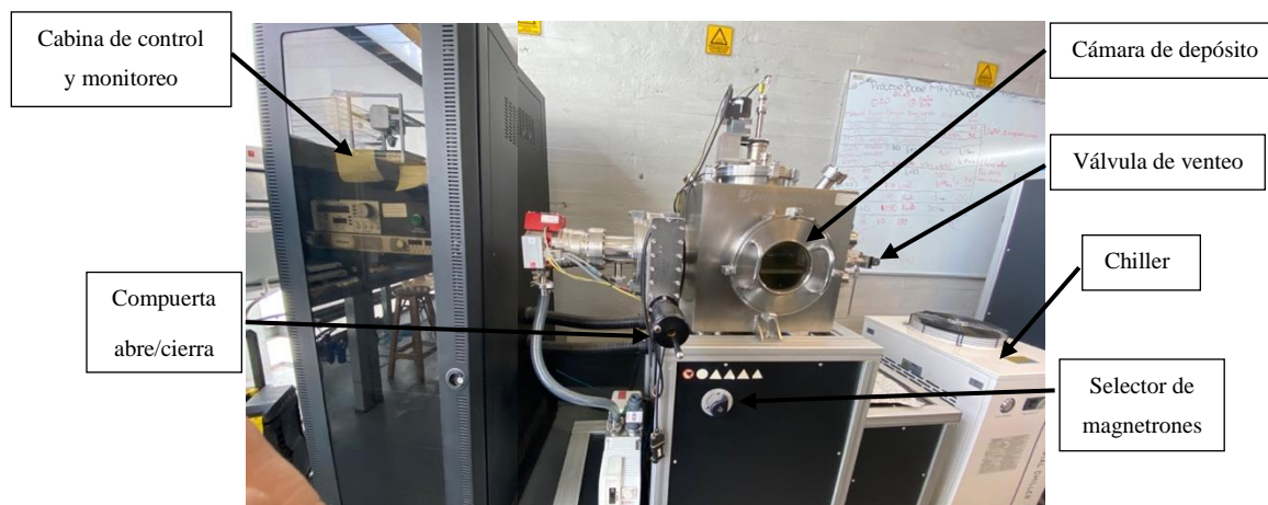
Figura 13. Sistema de erosión catódica magneto planar de radiofrecuencia (Sputtering-RF) para el crecimiento de ZnO/CdS.
