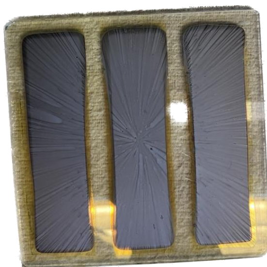
Figura 20. Muestra con depósito de PEDOT:PSS por Spin Coating sobre \text{CdCl}_2 .
