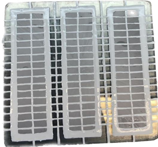
Figura 26. Aislamiento del módulo con tinta policat.
