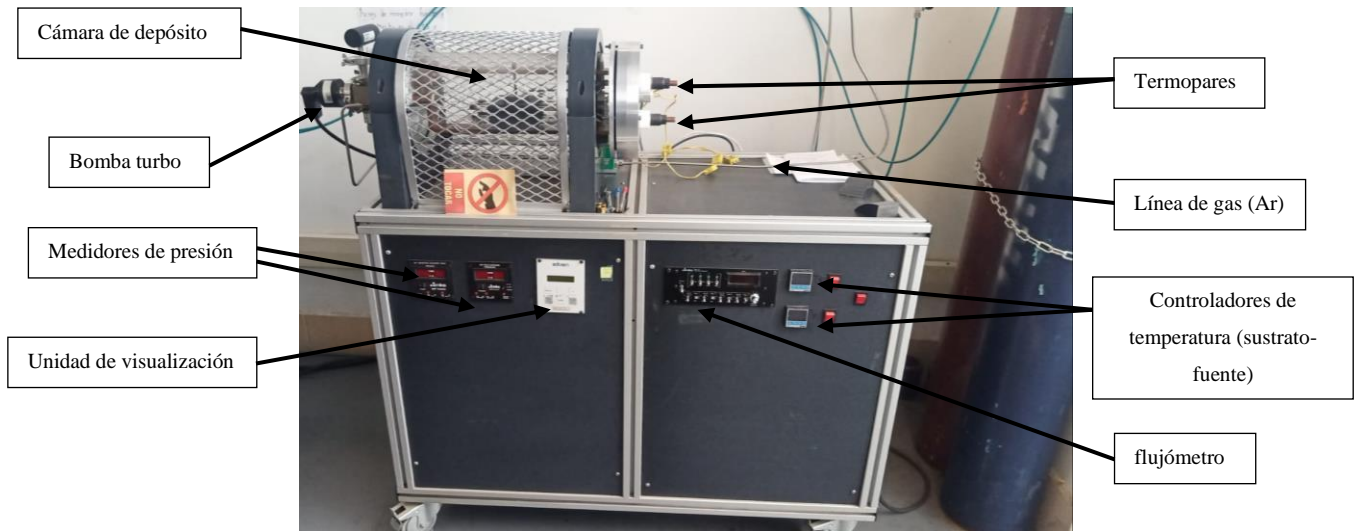
Figura 17. Sistema CSSVT (Close Space Vapor Transport) para el crecimiento de \text{CdCl}_2 .
