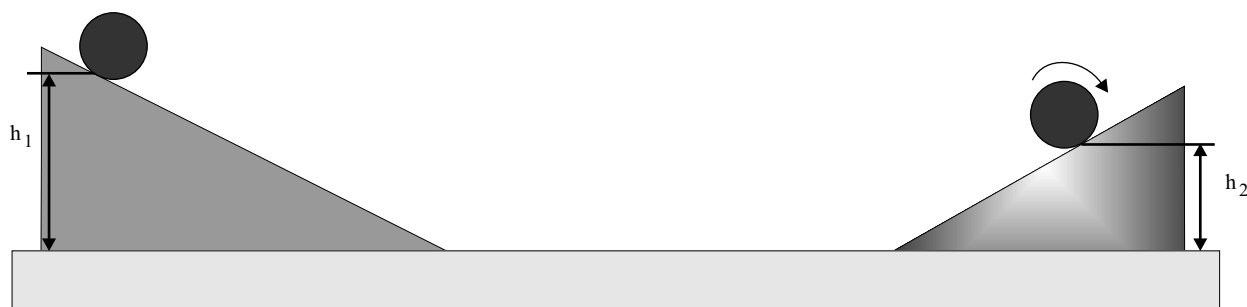
Figura 12.25: Una bolita sólida desciende sobre una rampa con fricción, posteriormente se mueve sobre una superficie horizontal girando sin resbalar y finalmente asciende por una rampa girando y deslizándose.
