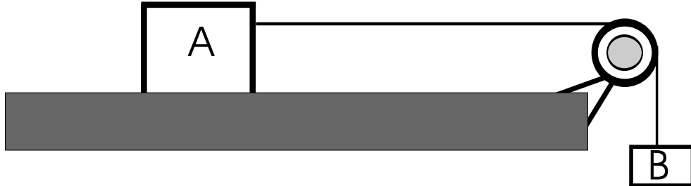
Figura 6.43: Sistema de dos bloques unidos por una cuerda que pasa por una polea sin fricción.
