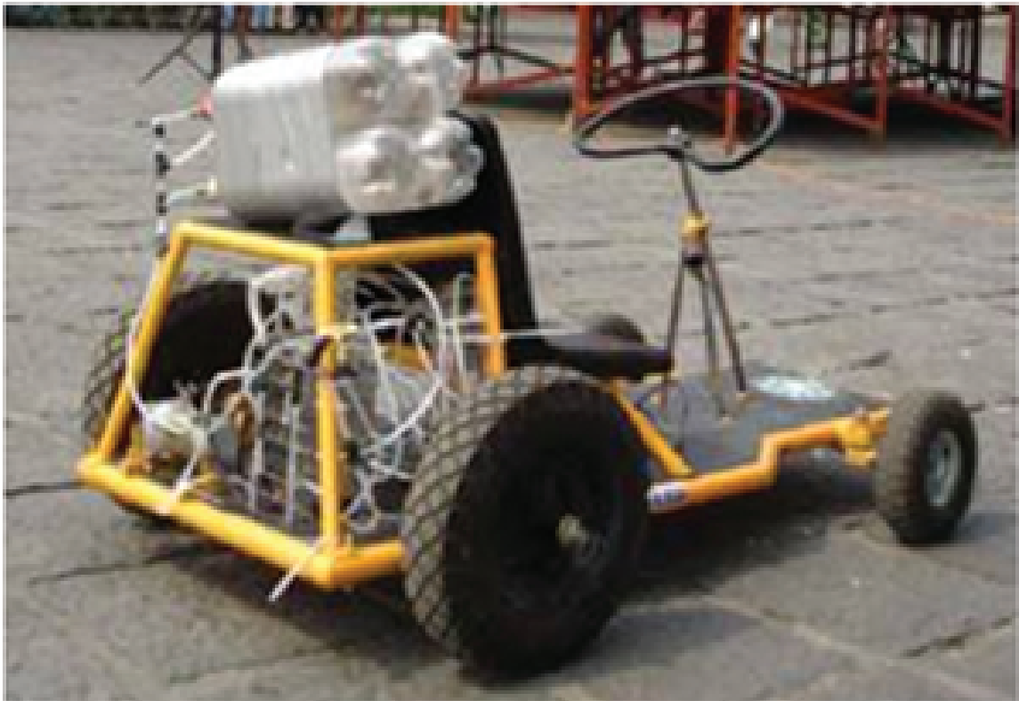
Figura 7. Sistema híbrido pila de combustible-baterías.
