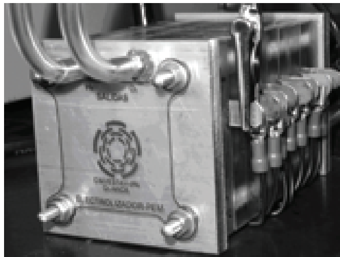
Figura 7. Sistema de siete ensambles de un electrolizador PEM.
