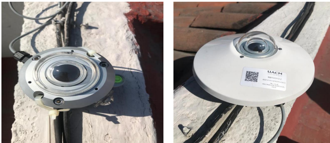
Figura 4.10. Montaje de piranómetro Delta OHM en la zona de estudio.
