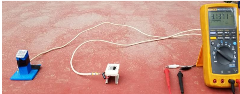
Figura 4.14. Prueba de medición de variables I_c y V_{oc} con multímetro Fluke 189.
