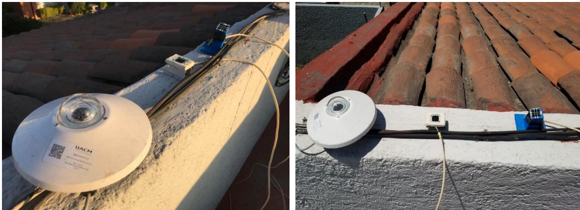
Figura 4.13. Montaje de prototipos de medición de CdTe, en conjunto con piranómetro Delta OHM.
