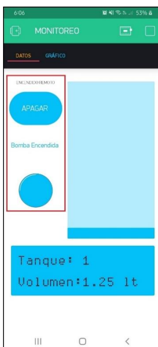
Figura 68. Encendido de la bomba por medio de la aplicación.
