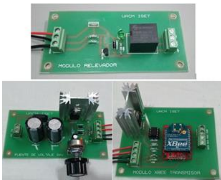
Figura 33. Tarjetas PCB: módulo relevador, fuente de alimentación, módulo transmisor.
