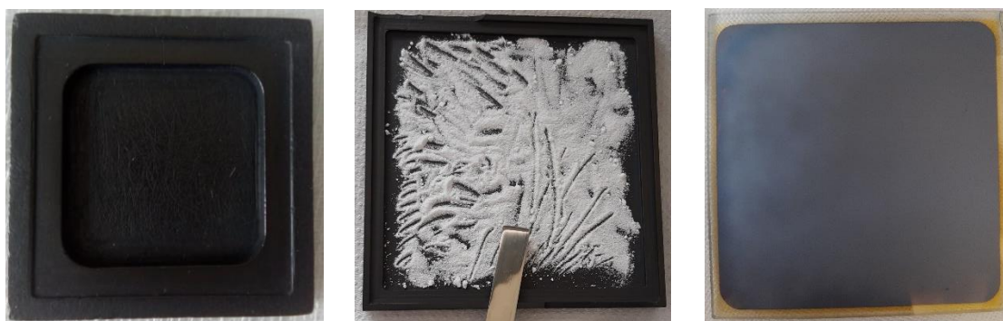
Figura 9. Del lado izquierdo se aprecia la chalupa limpia, en el centro la chalupa con \text{CdCl}_2 y del lado derecho el vidrio con \text{CdTe} .
