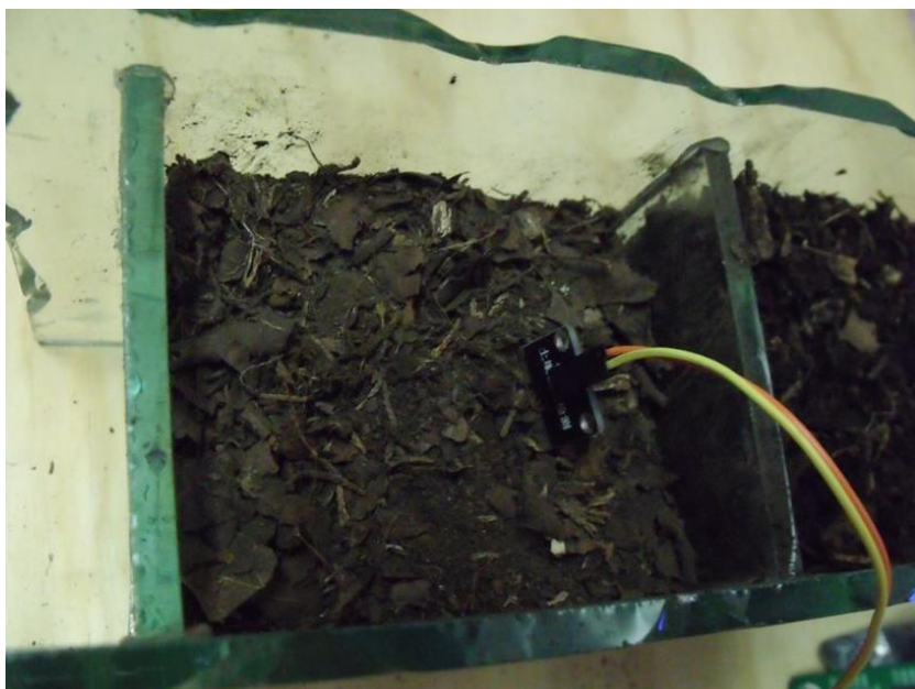
Figura 4.13 Sensor de humedad.
