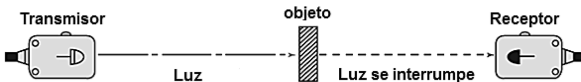
Figura 2.10. Funcionamiento de sensor óptico de barrera.
