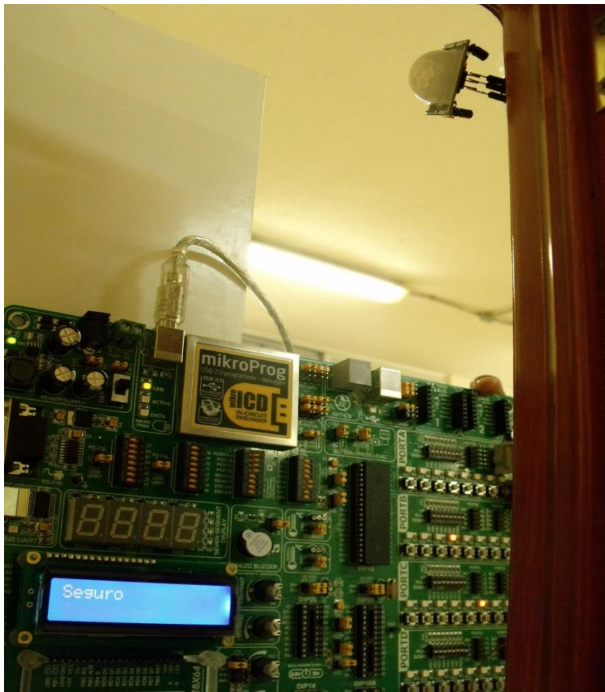
Figura 4.26. Sensor de movimiento, casa segura.
