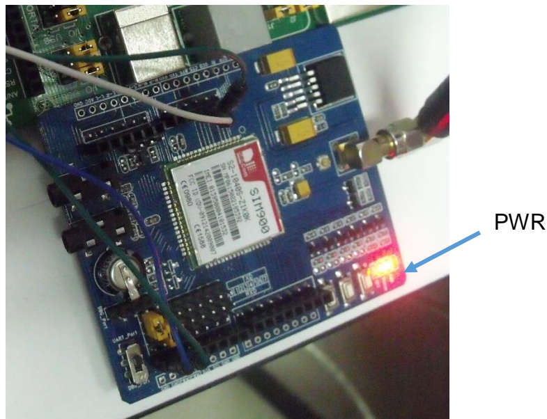
Figura 5.24. Botón PWR para reiniciar sistema.
