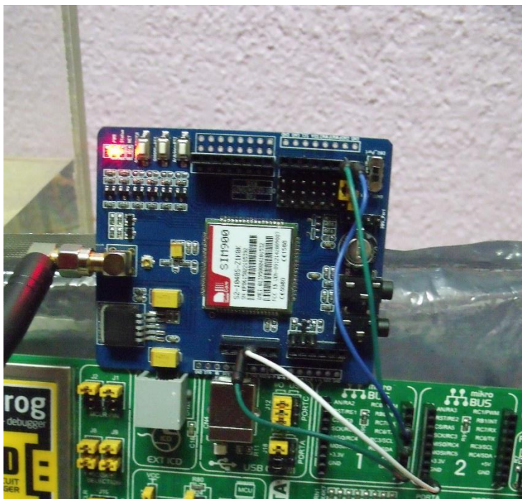
Figura 5.12. Conexión módulo de GSM y tarjeta de desarrollo Mikroelektronika.
