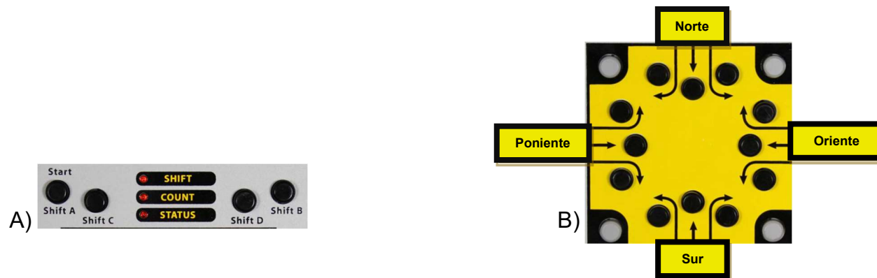
IBTM.1 Imagen de los botones en el tablero de los contadores manuales Epsilon NT, A) para la dirección de flujos y B) para la clasificación de tipo de Usuarios.
