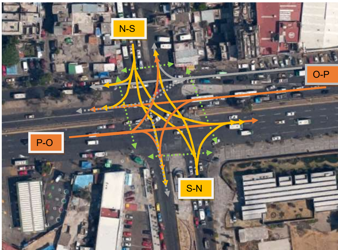
MCS.1 Movimientos percibidos y panel de los tiempos correspondientes del CS (Control Semafórico) en la intersección de Santa Cruz (Tinacos) con CEIE8S; Imagen base: (Google Maps, 2016). Datos: (SCM, 2016). Elaboración: (JFHP).
