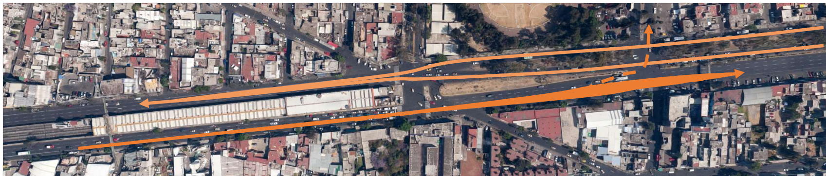
GM.6 Dirección de los flujos vehiculares de Calzada Ermita Iztapalapa Eje 8 Sur en la configuración de los carriles al extremo sur del deportivo Santa Cruz Meyehualco. Imagen Satelital adquirida en el sistema en línea Google Maps 2016. Elaboración: JFHP.
