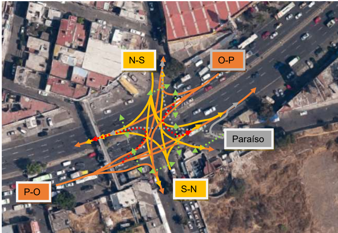
MCS.2 Movimientos percibidos y panel de los tiempos correspondientes del CS (Control Semafórico) en la intersección de Las Palmas, Las Minas y Paraíso con CEIE8S; Imagen base: (Google Maps, 2016). Datos: (SCM, 2016) (AM-AP, 2016). Elaboración: (JFHP).
