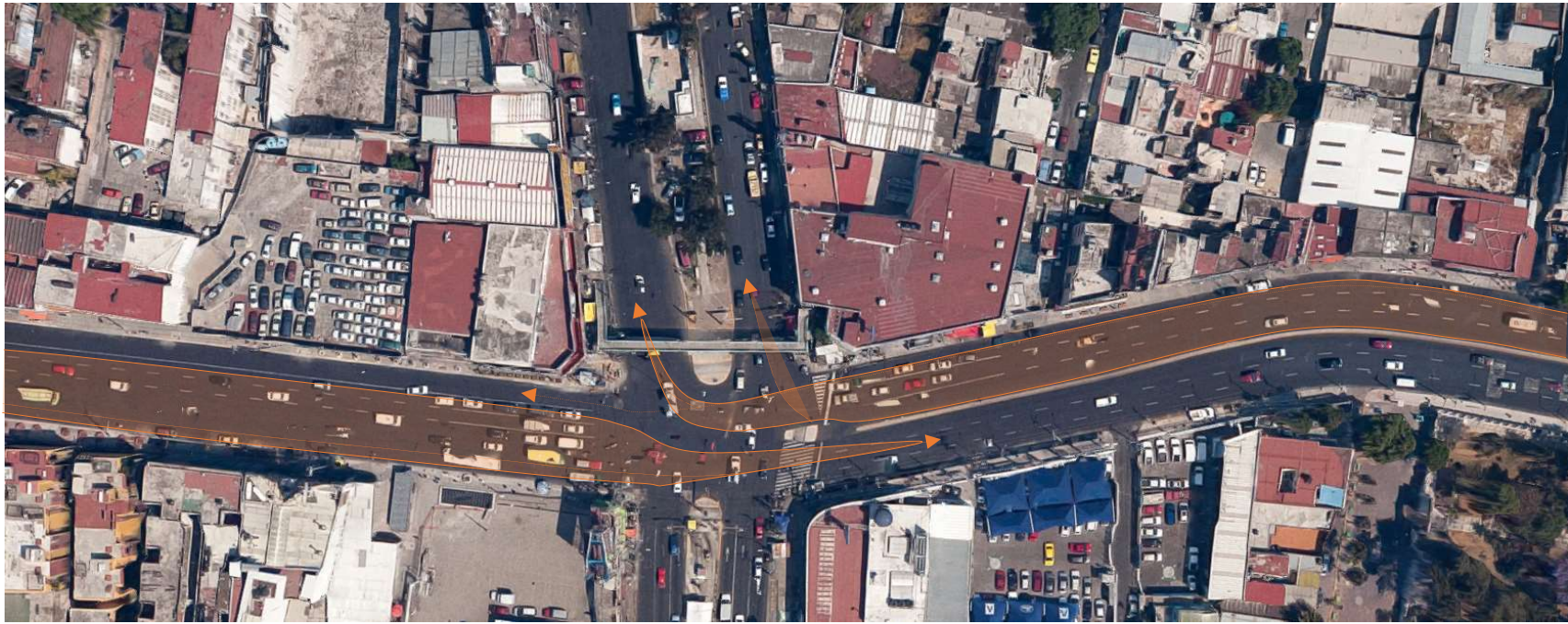
GM.2 Dirección de los flujos vehiculares de Calzada Ermita Iztapalapa Eje 8 Sur en la intersección con Calzada la Viga Eje 2 Oriente, donde cambia la configuración de CEIE8S presentando 2 sentidos en el acceso Oriente, separados por camellón. Imagen Satelital adquirida en el sistema en línea Google Maps 2016. Elaboración: (JFHP).
