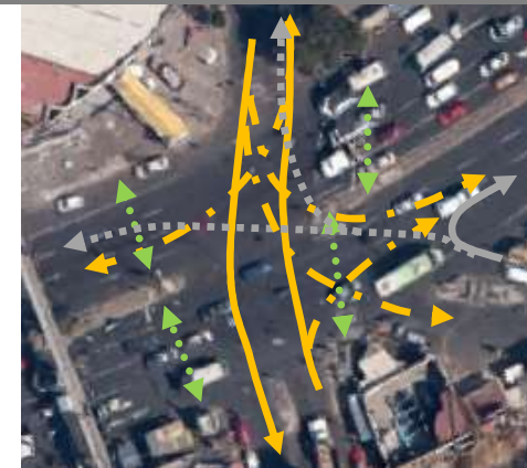
DF.2 Diagrama de Fases de los tiempos correspondientes del CS (Control Semafórico) en la intersección de Las Palmas, Las Minas y Paraíso con CEIE8S; Imagen base: (Google Maps, 2016). Datos: (SCM, 2016) (AM-AP, 2016). Elaboración: (JFHP).
