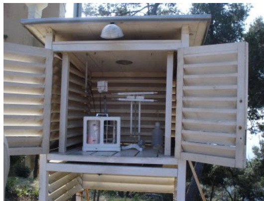
Figura 1.2: Caseta Meteorológica o Caseta de Stevenson
