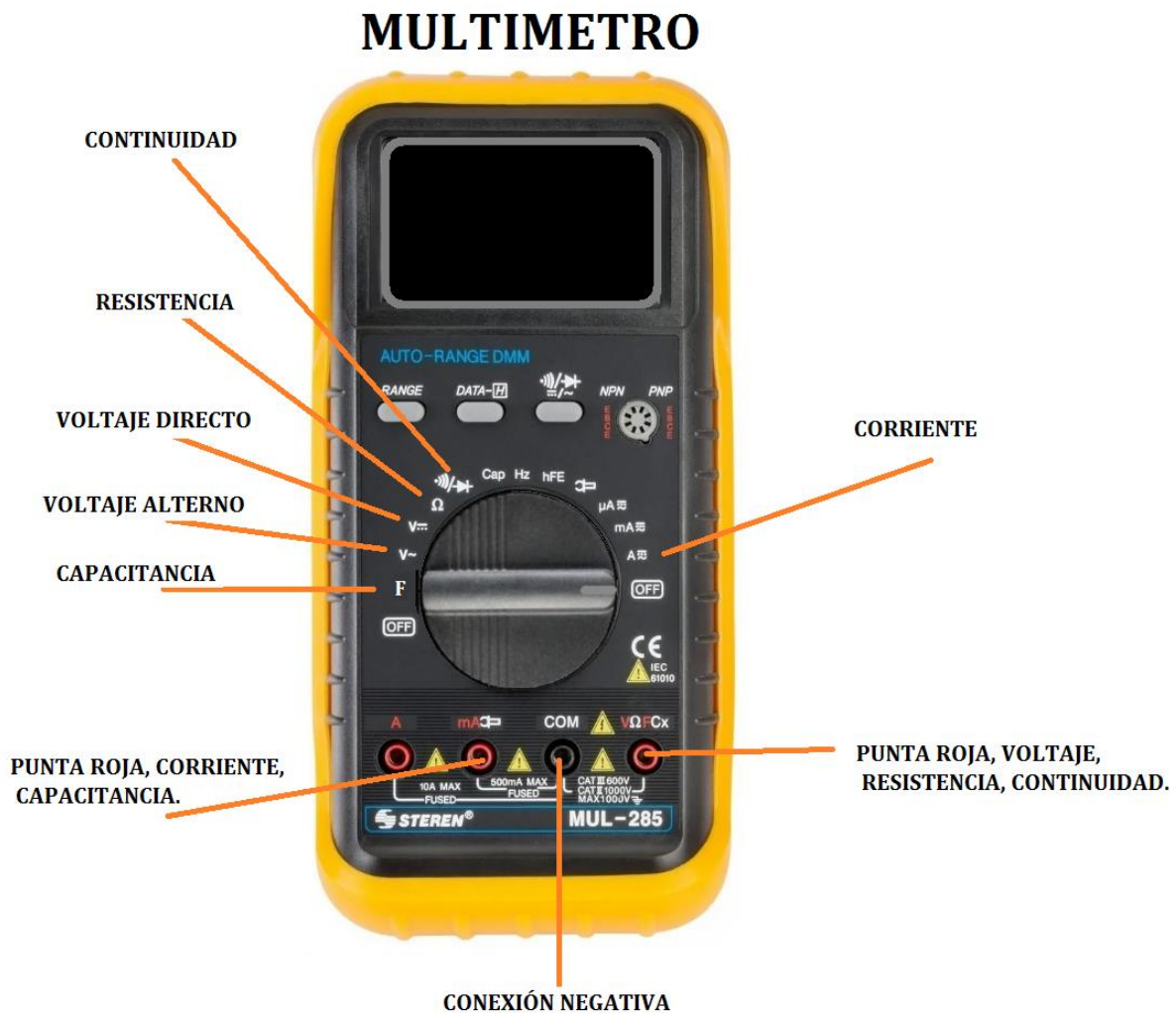
Figura 76. El multímetro (Diagrama propio basado en [25]).
