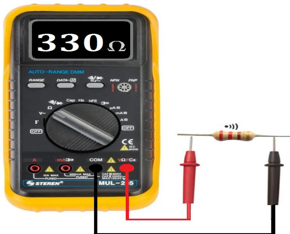
Figura 79. Medición de resistencia (Diagrama propio basado en [25]).
