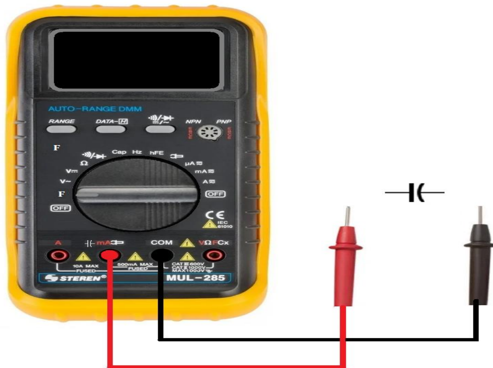
Figura 78. Medición de capacitancia (Diagrama propio basado en [25]).
