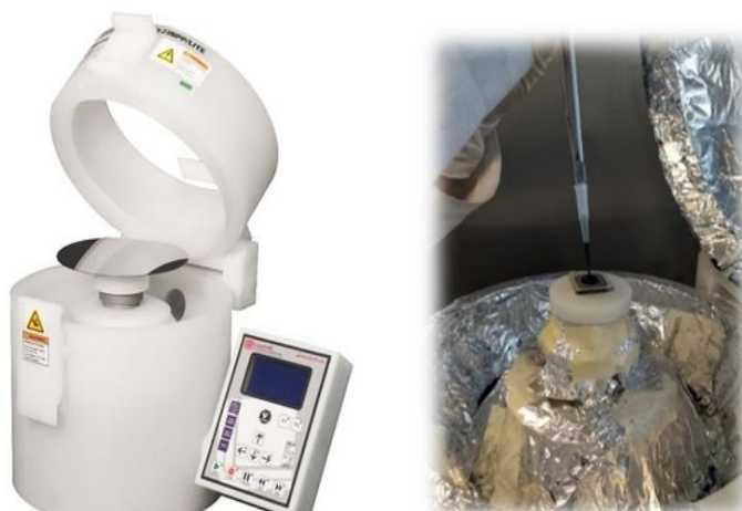
Figura 35 – Izquierda: Spin-Coating modelo WS-650 para películas delgadas. Derecha: Depósito de película delgada de PEDOT:PSS sobre CdTe.
