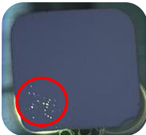
Figura 4 – Muestra después del depósito de CdTe. Se observan pinholes.
