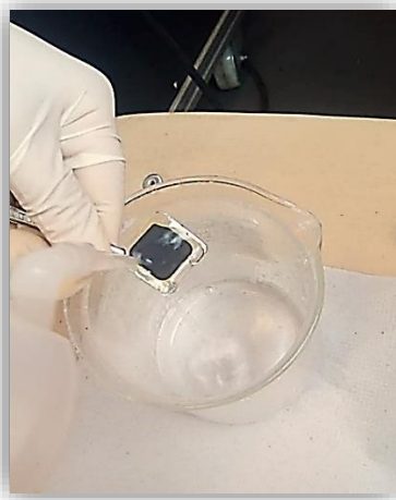
Figura 34 – Limpieza superficial del \text{CdCl}_2 sobre el CdTe después del TT en mufla.
