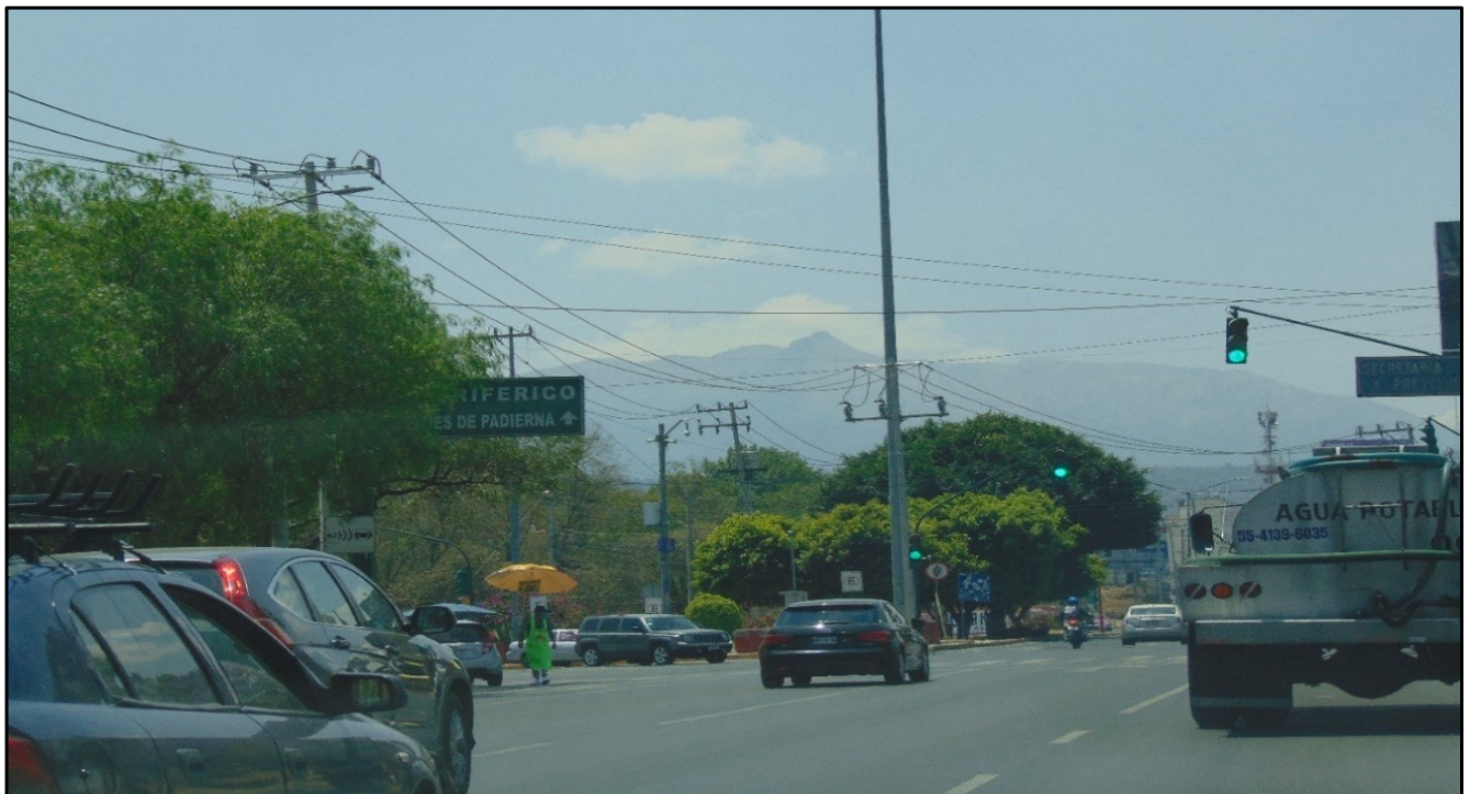
Figura 26 Señalamientos Viales Obstruidos por Árboles Fuente: Elaboración propia, fotografía capturada sobre la Ctra. Picacho Ajusco, CDMX.
