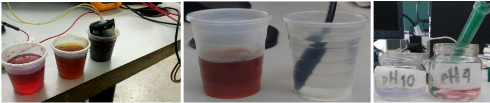
Figura 3.8.1: Calibración de sensores.
