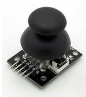
Figura 2.10.1: Joystick o palanca de mando.
