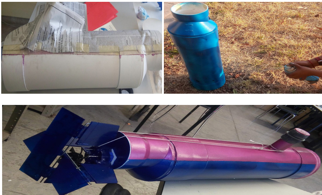
Figura 3.8.10: Ensamble de los timones y hélice
