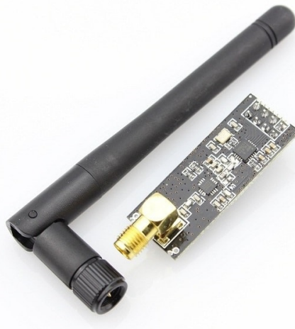
Figura 2.6.1: Módulo de comunicación NRF24L01.
