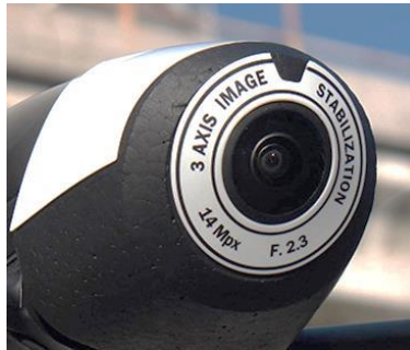
Imagen 26. Cámara del drone Bebop 2.
