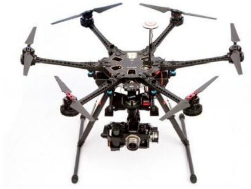
Imagen 15. Drone Hexacóptero en forma de X.
