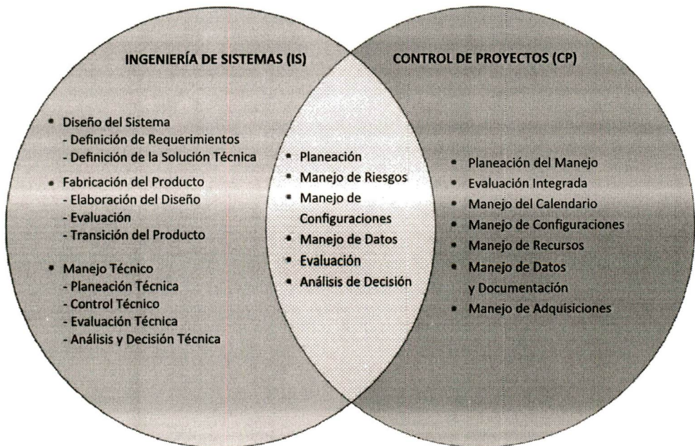
Figura 2.1. Ingeniería de Sistemas (IS) en el contexto del Manejo de Proyectos (PM) . Fuente: National Aeronautics and Space Administration, 2007.
