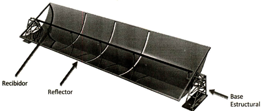
Figura 2.13. Subsistema MCCP y sus elementos básicos. Fuente: PowerGIE, 2013.
