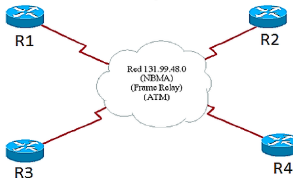
Figura 2.17. Topología NBMA o de acceso múltiple sin broadcast. Diagrama con base en la referencia [47].
