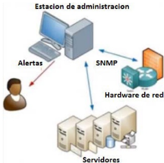
Figura 2.28 Diagrama típico de la arquitectura SNMP dentro de una red IP [59].
