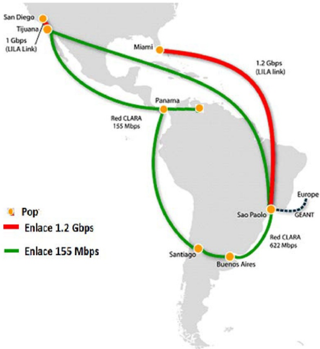
Figura 1.11. Enlaces proporcionados por WHREN/LILA para conexión de CLARA con EUA en 2004. Diagrama tomado de la referencia [31].
