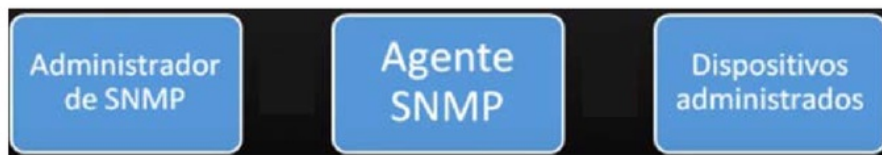
Figura 2.27. Componentes básicos de SNMP [59].
