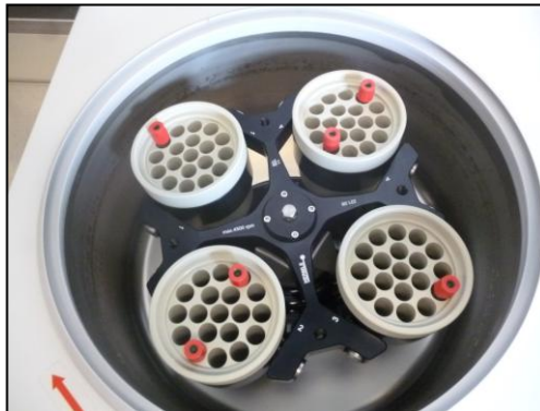
Figura 9. Separación del suero del paquete celular. Las muestras se centrifugaron a 3,000 rpm en la centrifuga refrigerada, marca Hermle Z400 durante 10 minutos a temperatura ambiente.
