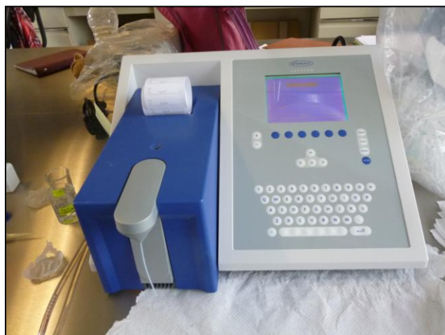
Figura 14. Equipo semiautomatizado de química clínica, marca SPINLAB. A) En el equipo se realizaron las determinaciones de glucosa, triglicéridos, colesterol total, colesterol HDL y colesterol LDL en sangre. B) Lectura de las determinaciones.
